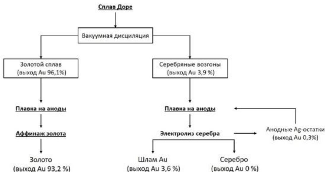
Рисунок 7.1. Принципиальная технологическая схема переработки сплава Доре с применением вакуумной дистилляции
