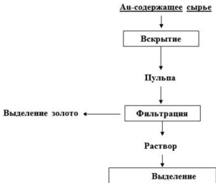
Рисунок 3. Принципиальная схема аффинажа золота
