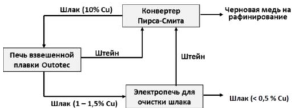
Рисунок 5.19. Переработка медного шлака в электродуговой печи
