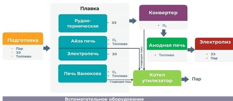
Рисунок .1. Укрупненная потоковая схема потребления энергоресурсов
