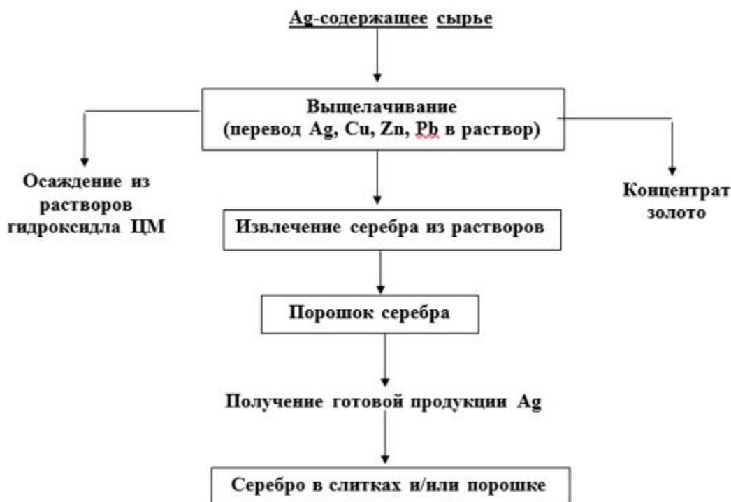
Рисунок 3.5. Основные этапы переработки серебросодержащего сырья
