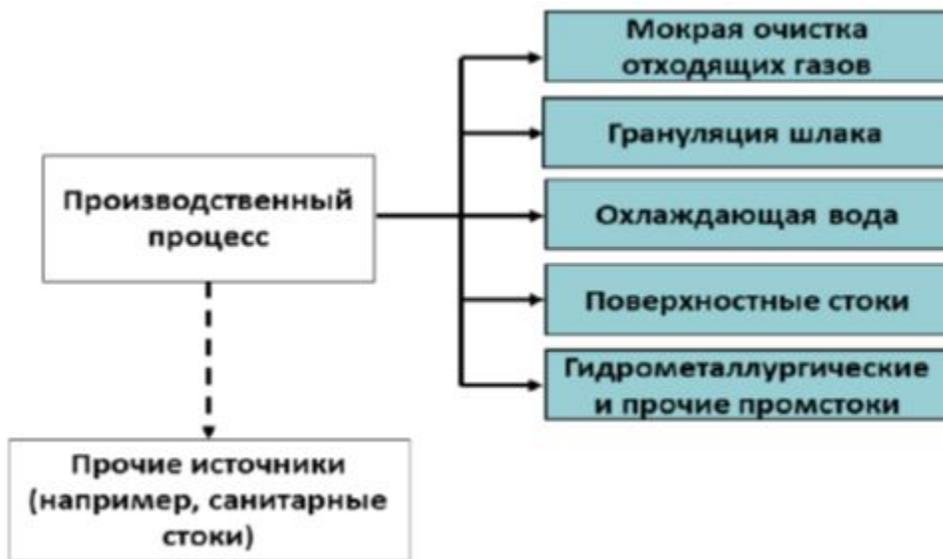
Рисунок 1.4. Классификация сбросов сточных вод
