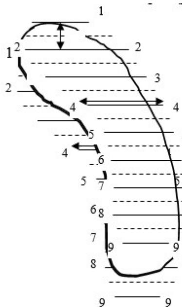
Рисунок 2. Определение площади участка неправильной формы:
