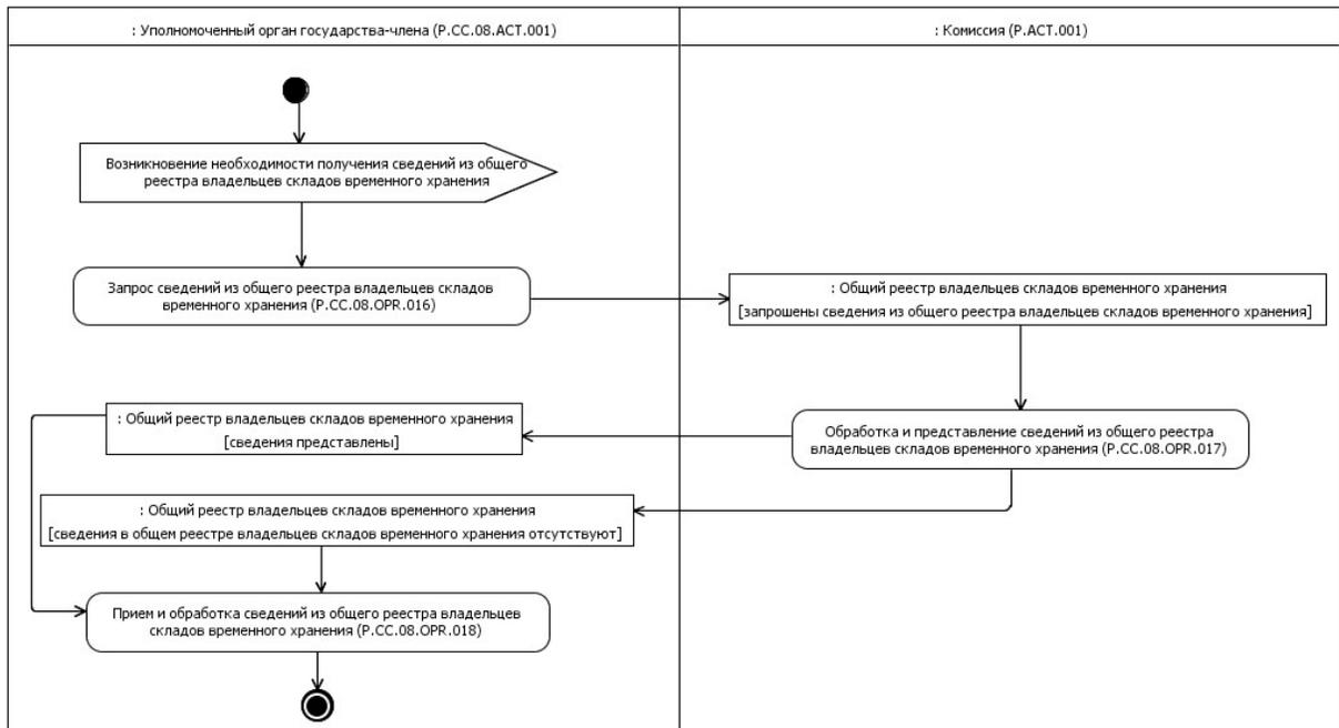
Рис. 9. Схема выполнения процедуры "Получение сведений из общего реестра владельцев складов временного хранения" (P.СC.08.PRC.005)
