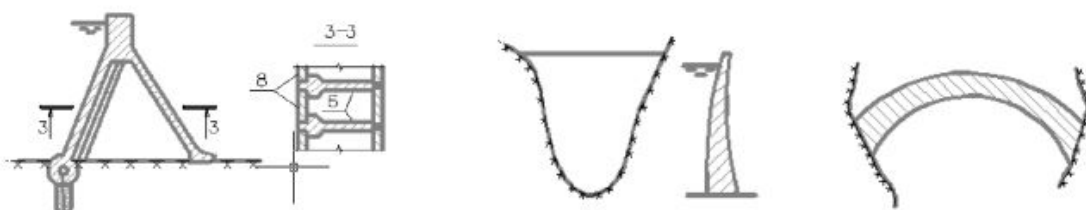
Рисунок 4- Схема разреза контрфорсной плотины с плоским перекрытием (8-плоское перекрытие)
