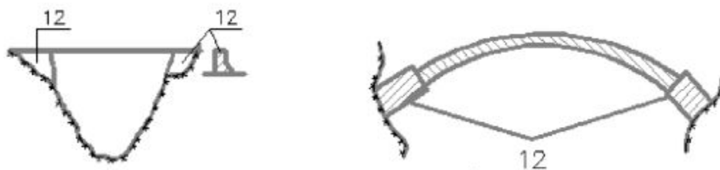
Рисунок 7 – Схема разреза арочной плотины с гравитационными устоями (12-гравитационные устои)
