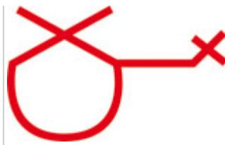
Мотопомпа пожарная: переносная
