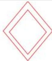
Станция пожаротушения диоксидом углерода
