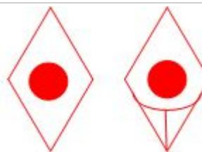
Установка водоаэрозольного пожаротушения
