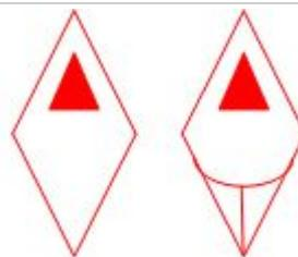
Станция пожаротушения прочим газом
