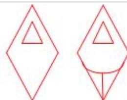
Установка газо-аэрозольного пожаротушения
