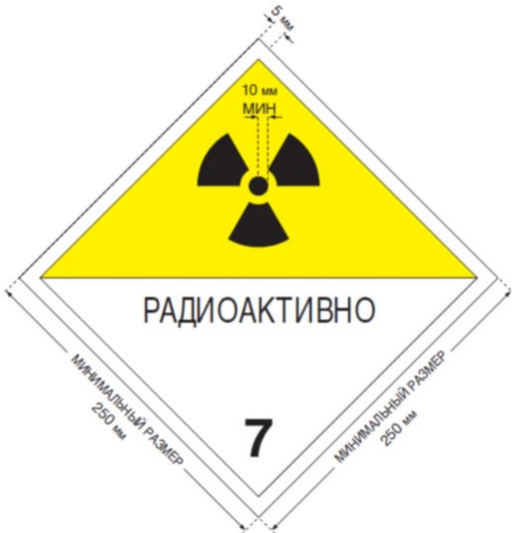
Рисунок 6. Предупредительный знак. Указаны минимальные размеры, при использовании больших размеров следует сохранять указанные пропорции. Высота цифры "7" не менее 25 мм. Цвет фона верхней половины знака – желтый, нижней половины – белый, цвет основного знака радиационной опасности (трилистника) и надписей – черный. Использование слова "РАДИОАКТИВНО" в нижней части необязательно, что позволяет применять этот знак для изображения соответствующего номера ООН для груза.
