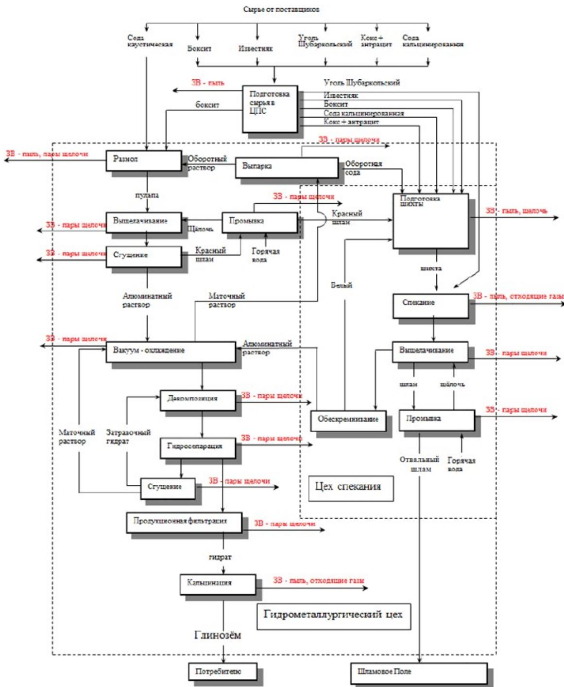
Схема производства глинозема с указанием эмиссий, образуемых в процессе производства глинозема
