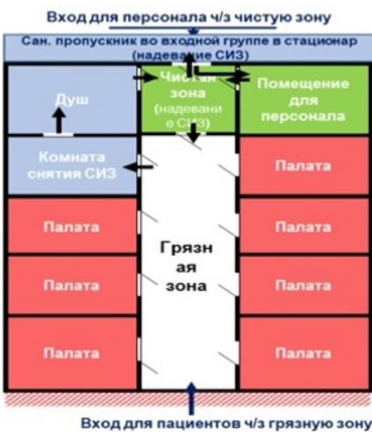
Схема модульного инфекционного стационара
