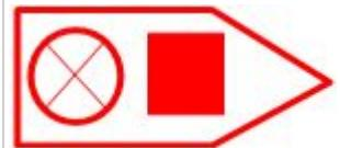
Автомобиль пожарный водо-аэрозольного тушения
