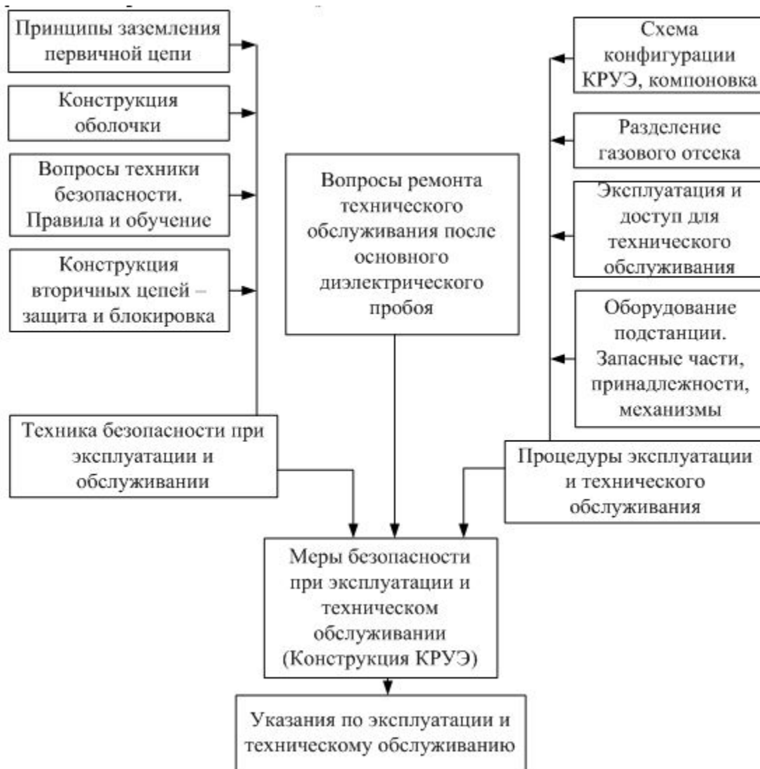
Рисунок 2 – Блок-схема для планирования обеспечения эксплуатации и технического обслуживания КРУЭ
