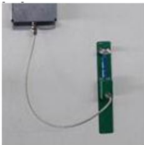
Рисунок 2 – Датчик электромагнитного типа ТМР-2, предназначенный для оперативных измерений по всем видам оборудования
