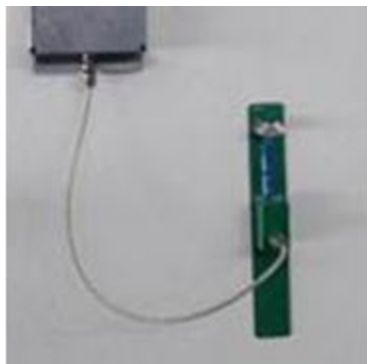
Рисунок 2 – Датчик электромагнитного типа ТМР-2, предназначенный для измерений на всех узлах.
