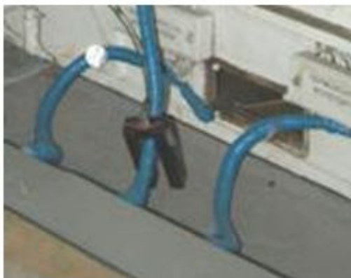
Рисунок 1 – Высокочастотный трансформатор тока "СТ-45" с разомкнутым сердечником
