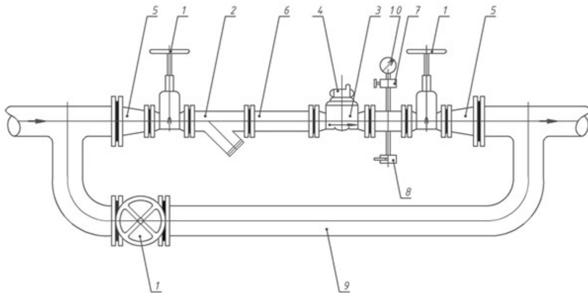
1 – запорная арматура, 2 – фильтр, 3 – прибор учета воды, 4 – средство дистанционной передач данных; 5 – переход; 6 – патрубок прямой, 7 – трехходовой кран, 8 – контрольно-спускной кран, 9 – обводная линия, 10 – манометр.
