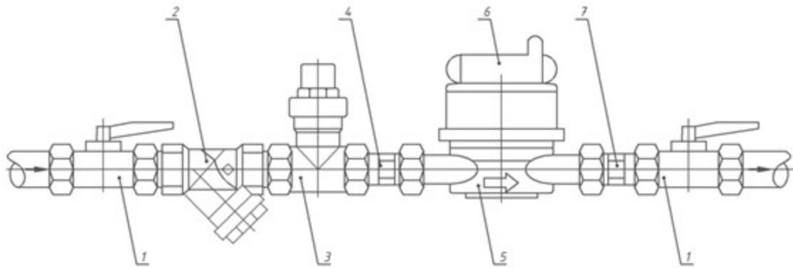
1 – кран, 2 – фильтр, 3\* – регулятор давления, 4 – соединительный штуцер с обратным клапаном, 5 – прибор учета воды, 6 – средство дистанционной передачи данных, 7 – соединительный штуцер.
