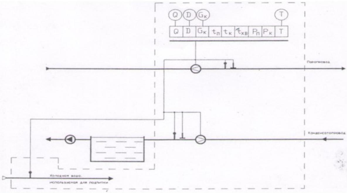
Схема размещения точек измерения количества тепловой энергии и массы (объема) теплоносителя, а также его регистрируемых параметров в закрытых системах теплоснабжения.
