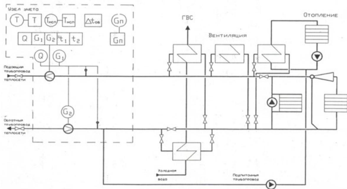
Схема размещения точек измерения тепловой энергии и массы (объема) теплоносителя, а также его регистрируемых параметров в открытых системах теплоснабжения с циркуляцией горячего водоснабжения.
