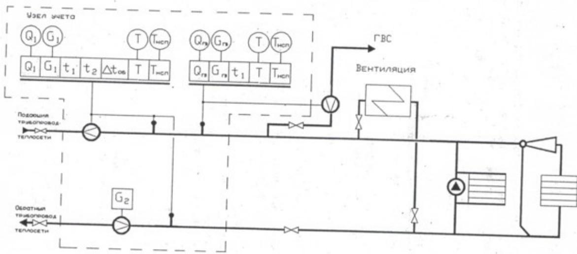
Схема размещения точек измерения количества тепловой энергии и массы (объема) теплоносителя, а также его регистрируемых параметров в паровых системах теплоснабжения.
