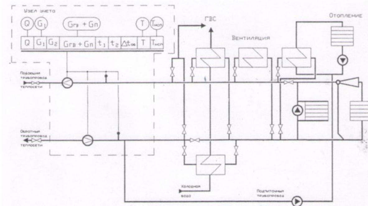
Схема размещения точек измерения количества тепловой энергии и массы (объема) теплоносителя, а также его регистрируемых параметров в открытых системах теплоснабжения без циркуляции горячего водоснабжения.
