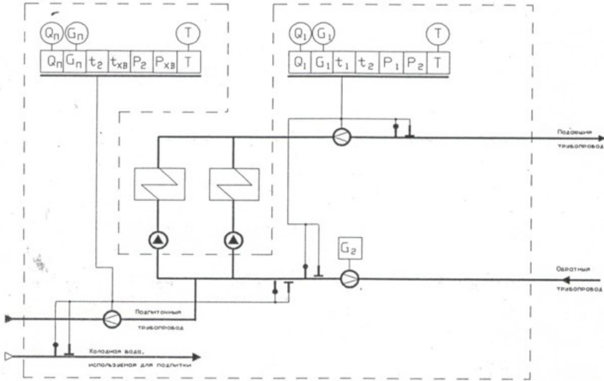
Схема размещения точек измерения количества тепловой энергии и массы (объема) теплоносителя, а также его регистрируемых параметров тепловой сети энергопроизводящей организации для паровых систем теплоносителя.
