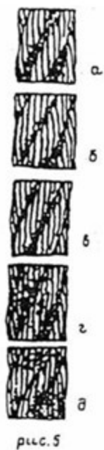
Рис. 5. Поверхностная коррозия проволок каната крестовой свивки:
