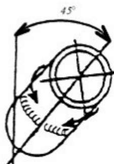
Ж-L045: наклонное положение (сверху вниз). Труба: неподвижная; ось: наклонная
