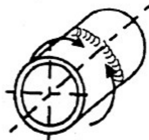
РФ: вертикальное положение (снизу вверх). Труба: неподвижная; ось: горизонтальная
