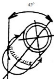
Н-L045: наклонное положение (снизу вверх). Труба: неподвижная; ось: наклонная
