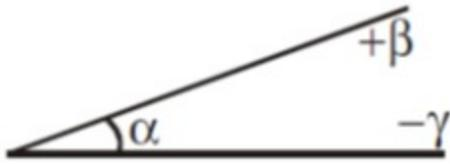
где  $\alpha$  – угол, измеренный при горизонтальном положении лицевой части (обращенной вверх) оборудования, для которого калибруется прибор, а  $\beta$  и  $\gamma$  являются, соответственно, максимальными допустимыми верхним и нижним отклонениями от угла калибрования  $\alpha$ .
