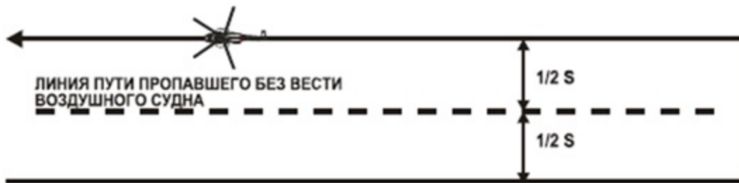
Рисунок 10. Метод поиска способом "Обследование линии пути с возвратом (TSR)"
