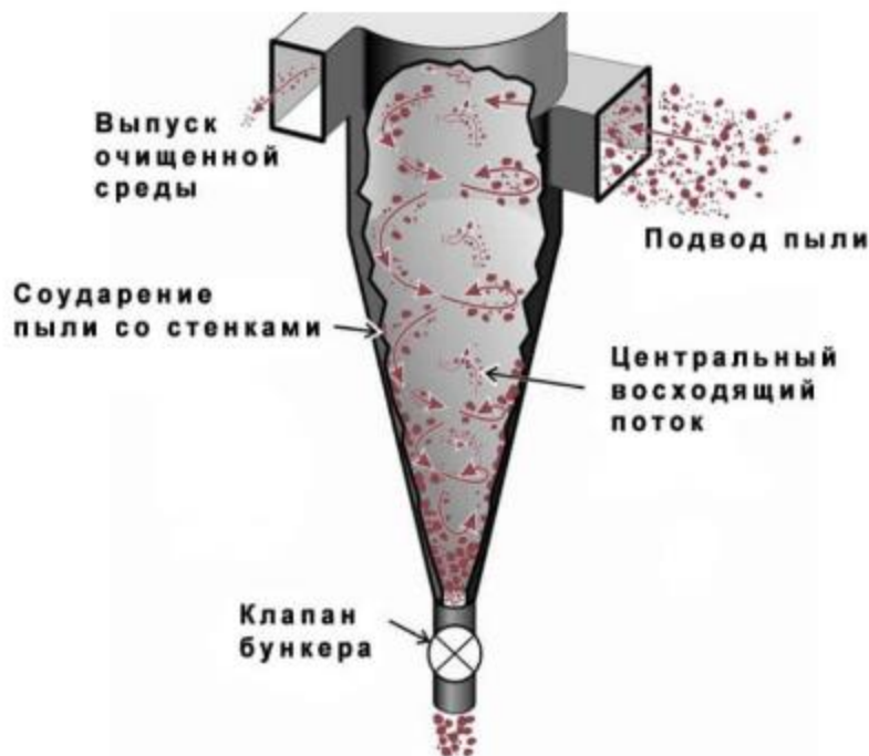
Рисунок 5.4. Базовая схема устройства циклона.
