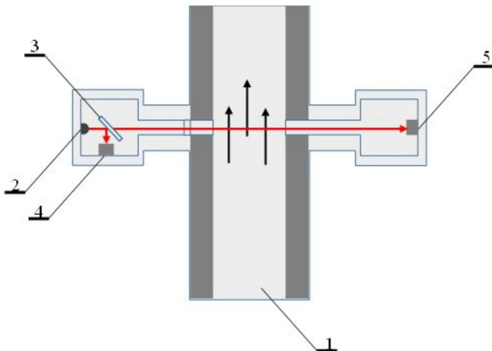
1 – газоход; 2 – источник излучения; 3 – делитель луча; 4 – детектор сравнения; 5 – детектор
