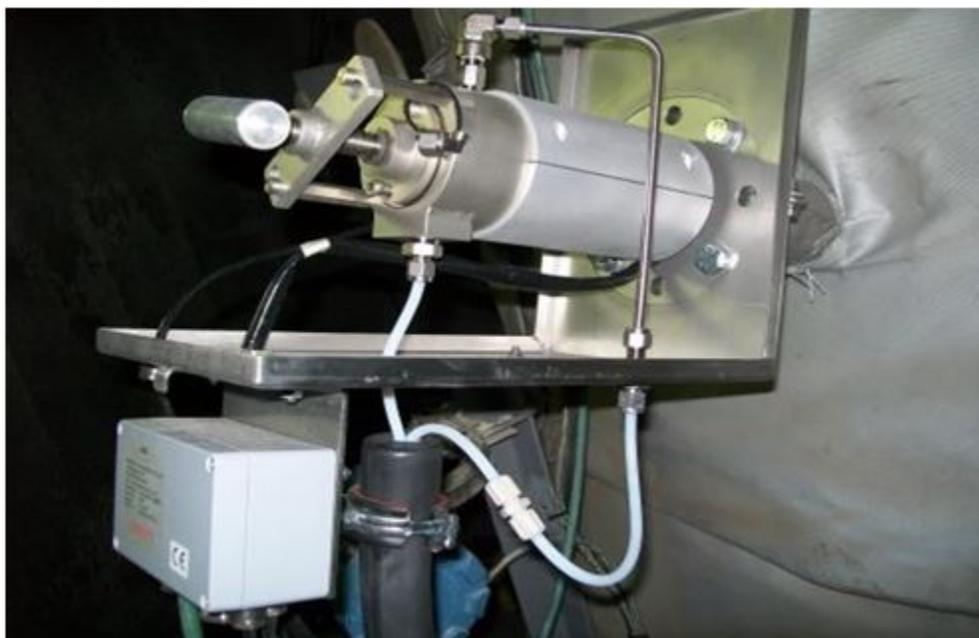
Рисунок 5.4. Пример устройства для экстрактивного отбора проб.
