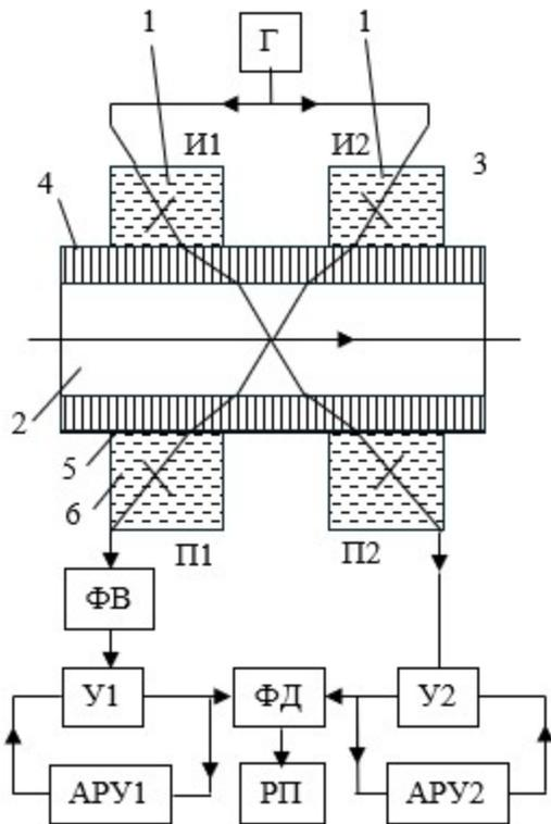
Рисунок 5.27. Технологическая схема ультразвукового расходомера фазного метода.
