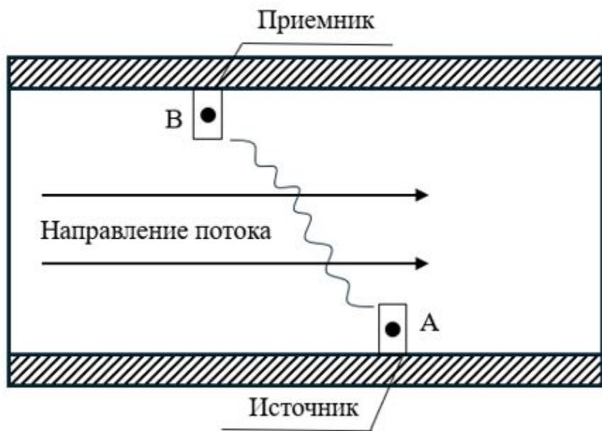
Рисунок 5.29. Принцип действия ультразвукового прибора учета воды.
