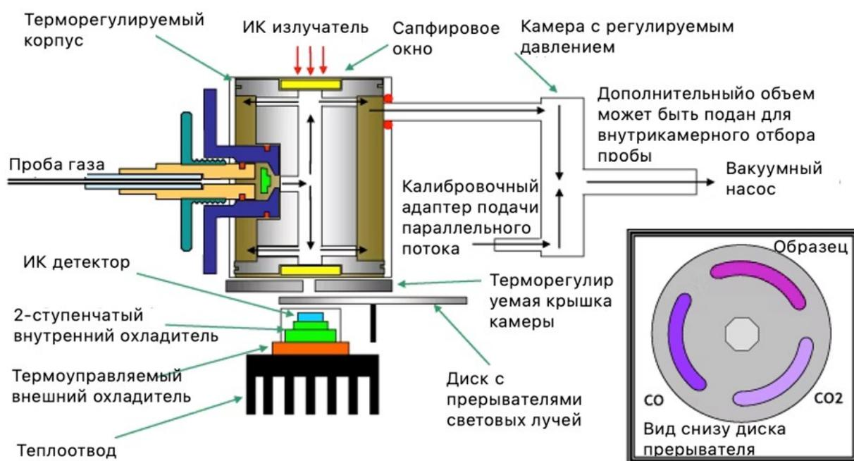
Рисунок 5.23. Технологическая схема нерассеивающего инфракрасного анализатора
