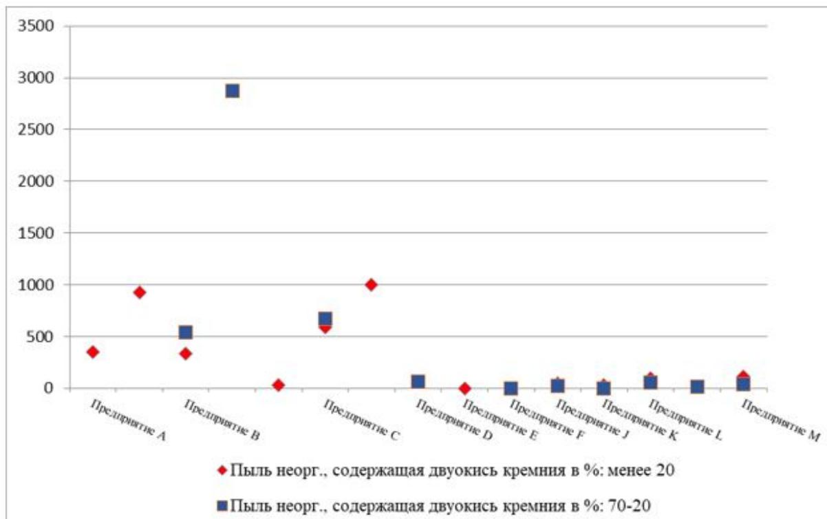
Рисунок 3.6. Концентрация пыли неорганической, содержащей двуокись кремния в %: менее 20 и 70 – 20, мг/Нм<sup>3</sup>.
