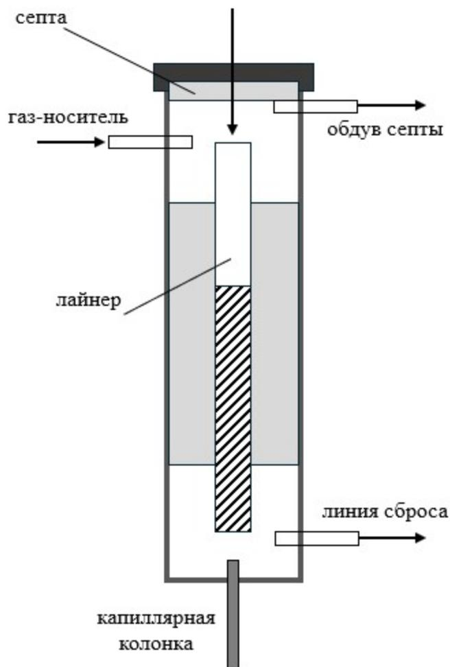
Рисунок 5.22. Технологическая схема газового хроматографа.
