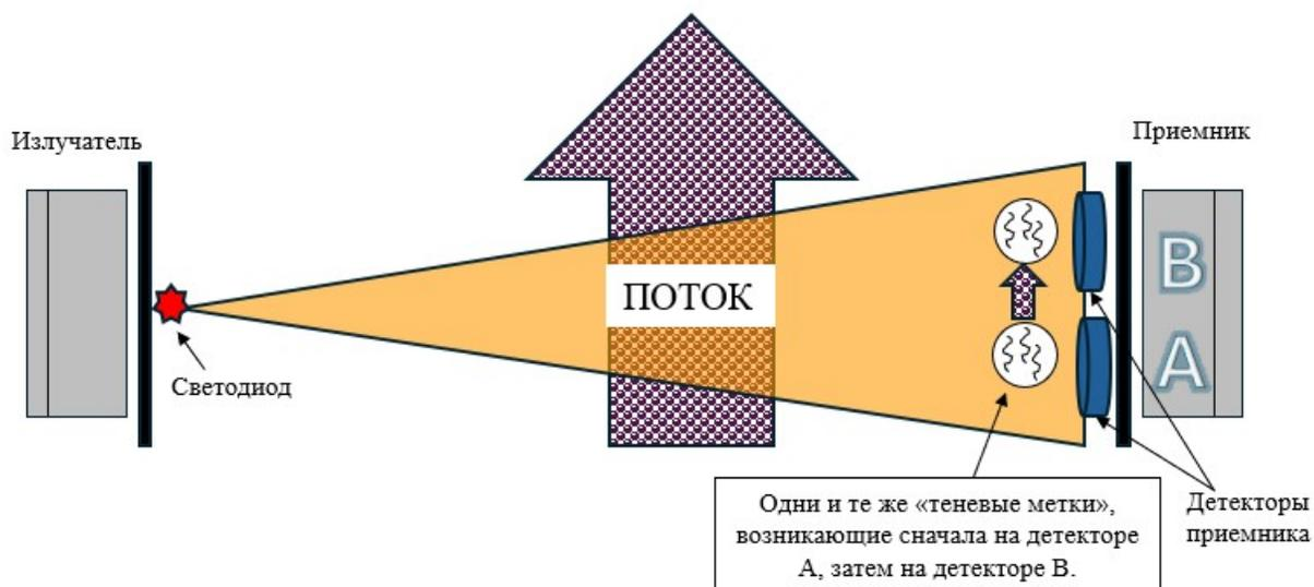
Рисунок 5.25. Технологическая схема оптического расходомера.
