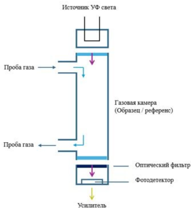
Рисунок 5.20. Технологическая схема недисперсионного ультрафиолетового анализатора.
