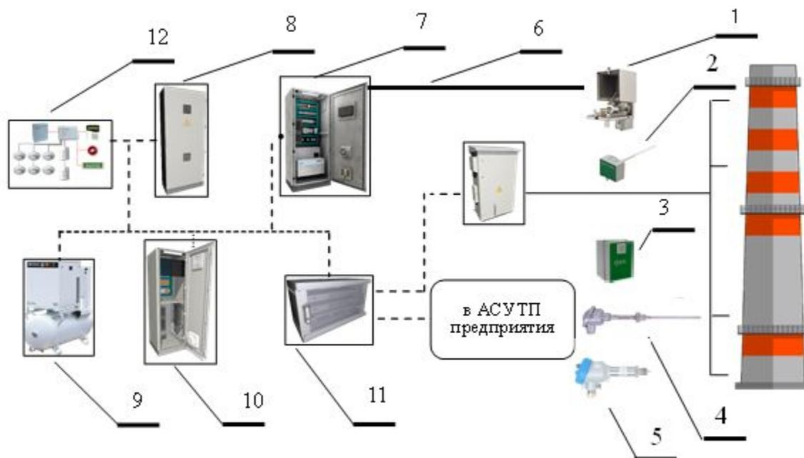
1 – пробоотборный зонд, 2 – измеритель скорости, 3 – измеритель пыли, 5 – датчик температуры, 6 – датчик абсолютного давления, 6 – пробоотборная линия, 7 – газоанализатор, 8 – шкаф собственных нужд, 9 – система подготовки сжатого воздуха, 10 – система передачи и обработки данных, 11 – коммуникационное устройство, 12 – охранно-пожарная сигнализация
