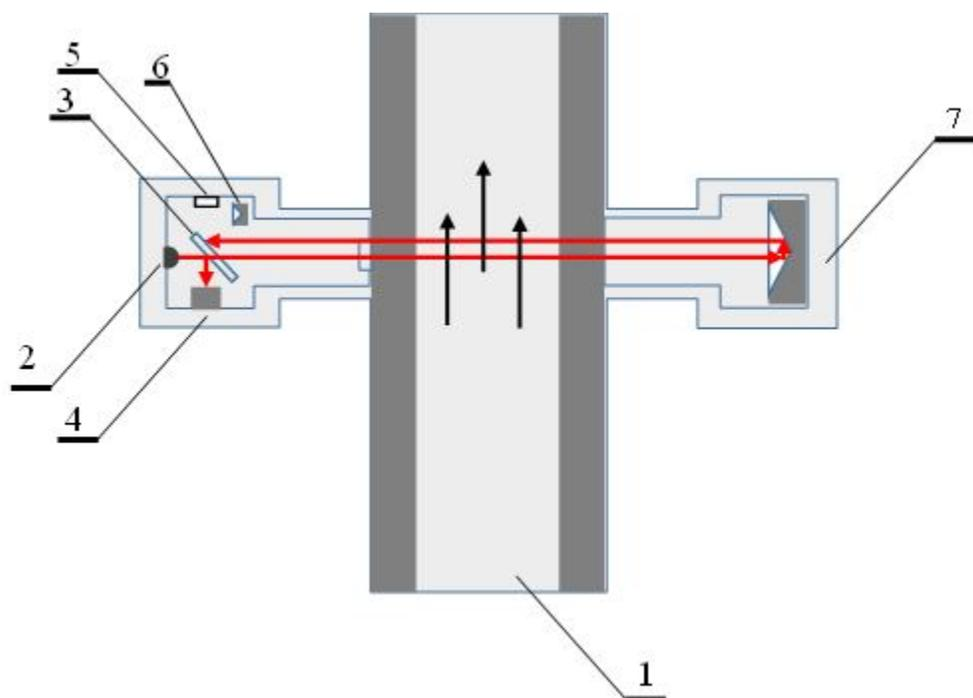
1 – газопровод; 2 – источник излучения; 3 – делитель луча; 4 – детектор сравнения; 5 – детектор; 6 – рефлектор для установки нулевой точки; 7 – отражатель
