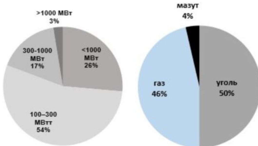
Рисунок 3.4. Структура топливосжигающих установок по мощности и виду топлива
