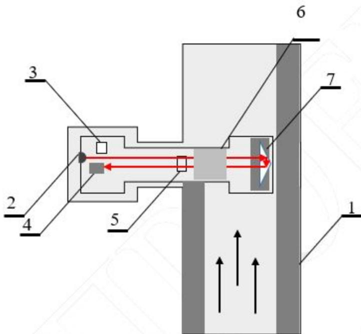
1 – газоход; 2 – источник ИК-излучения; 3 – поворотный фильтр для ИК-излучения; 4 – приемник ИК-излучения; 5 – линза; 6 – пористый наполнитель; 7 – отражатель.
