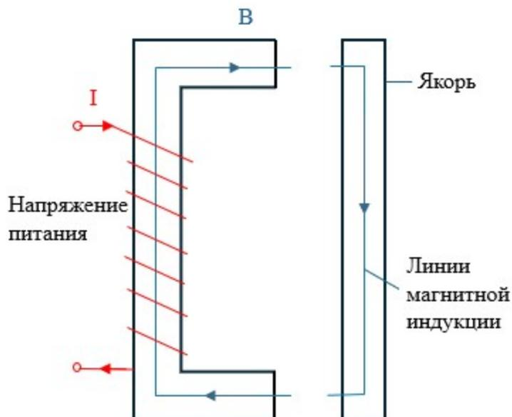
Рисунок 5.33. Магнитное поле при срабатывании в процессе проточного анализа.
