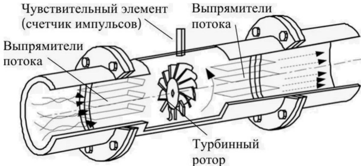
Рисунок 5.31. Принцип действия прибора учета воды с использованием механических счетчиков и импульсного выхода.
