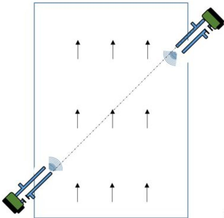
Рисунок 5.16. Применение ультразвука для непрерывного мониторинга в отходящих газах.
