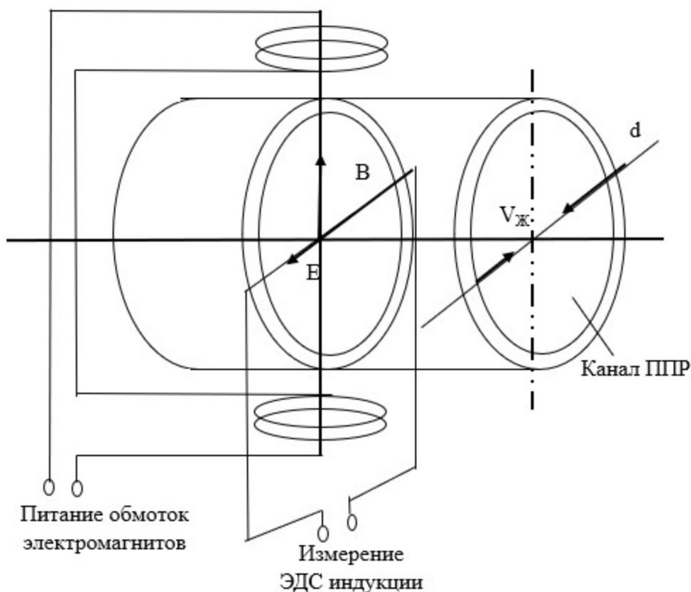
Рисунок 5.30. Принцип действия электромагнитного прибора учета воды.
