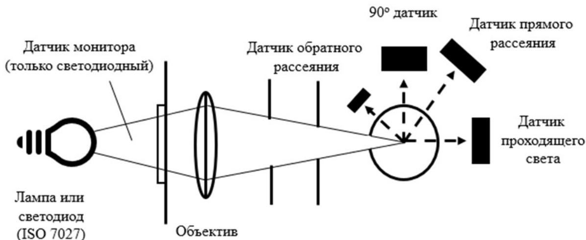
Рисунок 5.34. Принцип действия оптических турбидиметров (фотометр).
