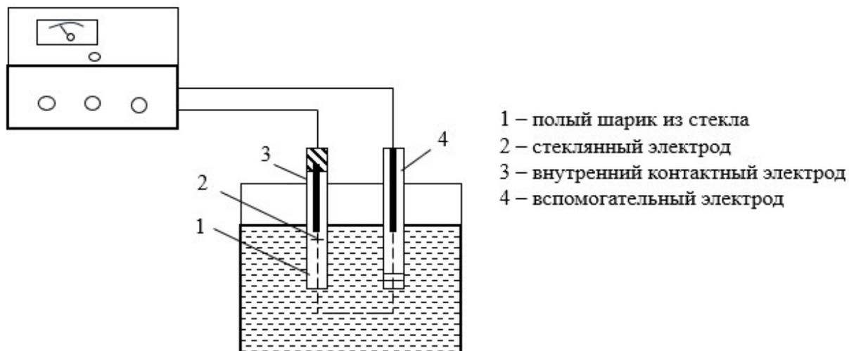
Рисунок 5.32. Принцип действия датчиков измерения водородного показателя (рН) вод.
