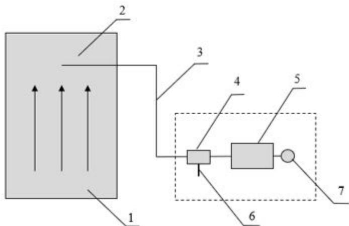
1 – газоход; 2 – зонд для отбора пробы; 3 – обогреваемая линия для транспортировки пробы; 4 – устройство для удаления влаги (холодильник); 5 – газоанализатор; 6 – линия для удаления конденсата; 7 – побудитель расхода (насос).
