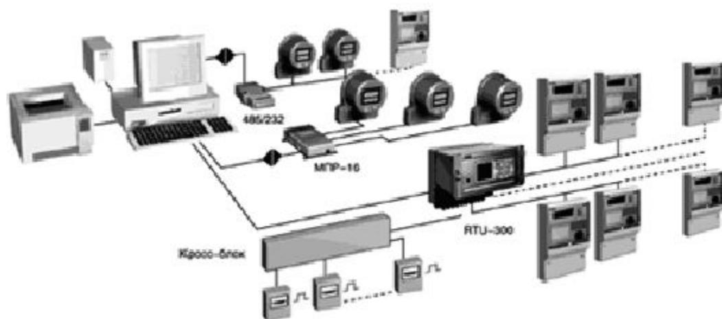
Рисунок 4.4. Типовая схема АСКУЭ с организацией автоматического опроса счетчиков локальным центром сбора и обработки данных.
