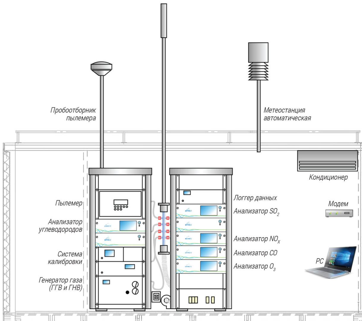
Рисунок 5.19. Технологическая схема стационарного поста.
