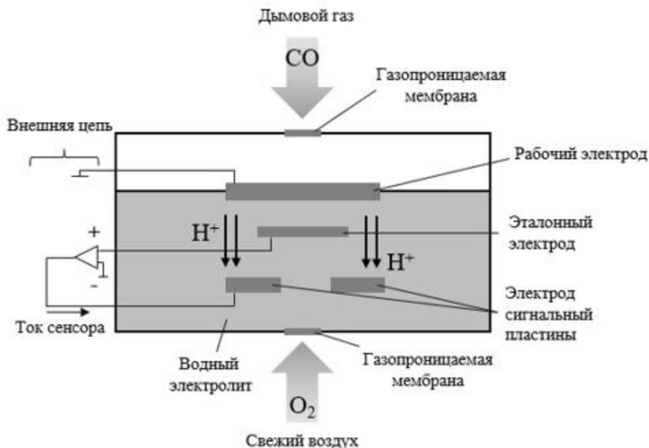
Рисунок 5.24. Технологическая схема электрохимического анализатора.
