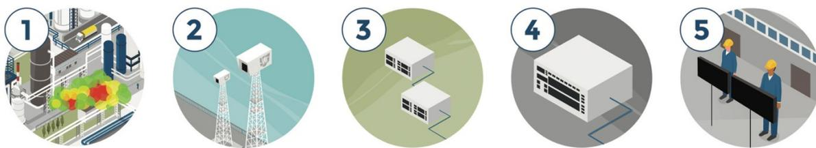
1 – выброс газа на объекте; 2 – CGI камеры обнаруживают выброс; 3 – анализатор обрабатывает данные в режиме реального времени для обнаружения, идентификации и отслеживания источника утечки газа; 4 – система цифровой видеозаписи отправляет результаты записи и ее анализа оператору; 5 – операторы могут принять соответствующие действия.
