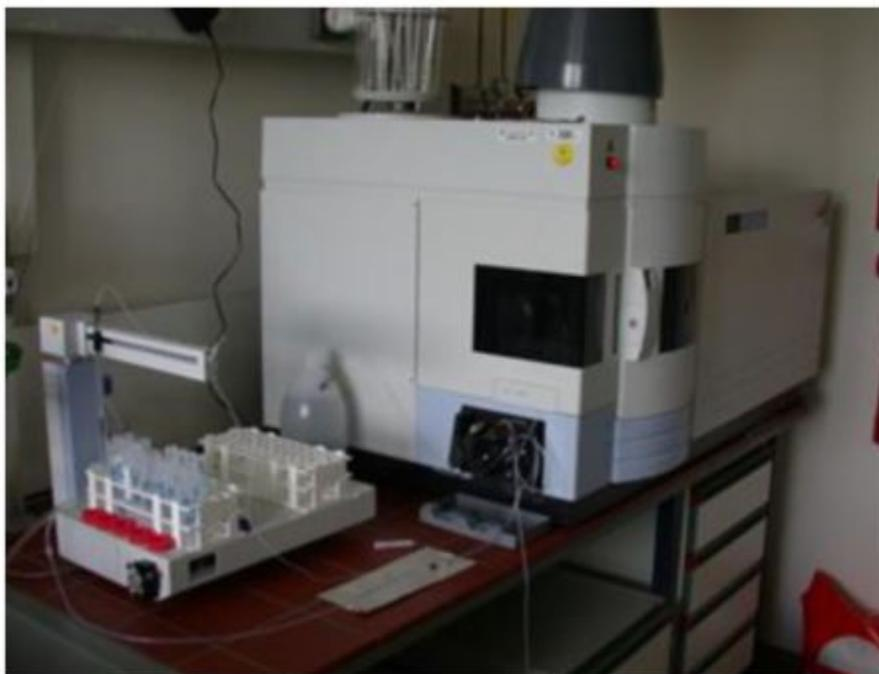
Рисунок 4.2. Пример оптико-эмиссионного спектрометра с индуктивно связанной плазмой.
