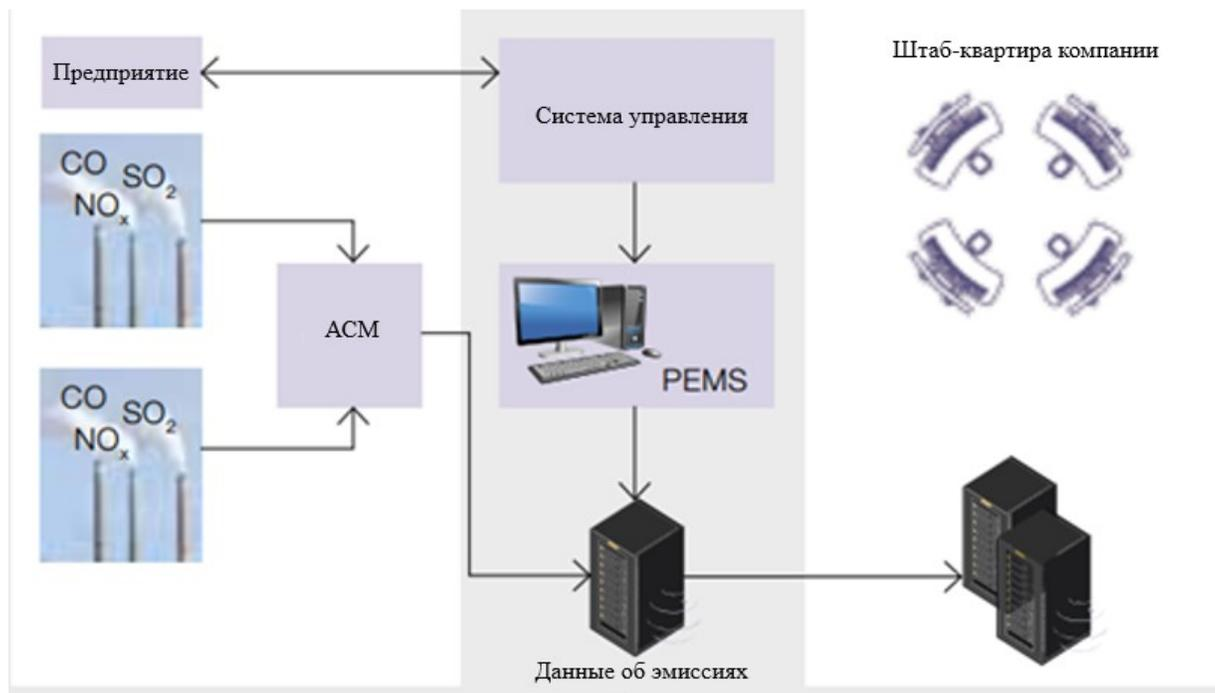
Рисунок 7.1. Возможная схема комбинации АСМ (СЕМС) и РЕМС (СЕМС – это английский эквивалент аббревиатуры АСМ).
