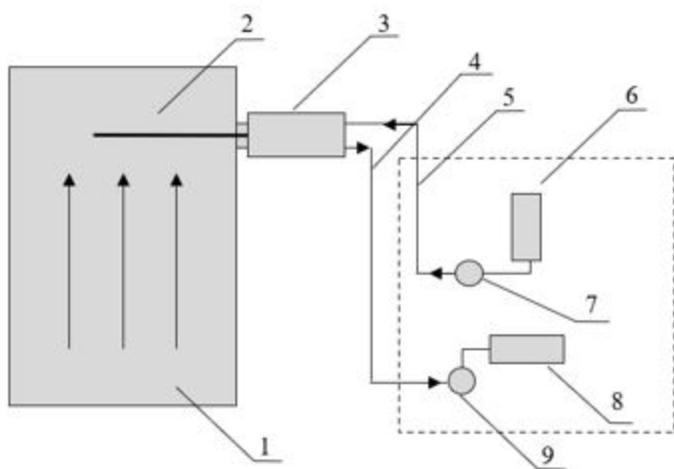
1 – газоход; 2 – зонд для отбора пробы; 3 – устройство для разбавления пробы; 4 – линия подачи разбавленной пробы; 5 – линия подачи газа-разбавителя; 6 – устройство для очистки газа-разбавителя; 7 – побудители расхода (насос); 8 – газоанализатор
