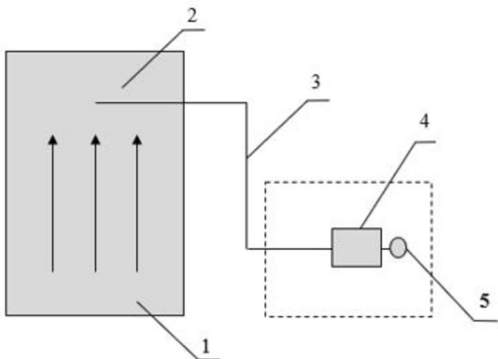
1 – газоход; 2 – зонд для отбора пробы; 3 – обогреваемая линия для транспортировки пробы; 4 – газоанализатор; 5 – побудитель расхода (насос).
