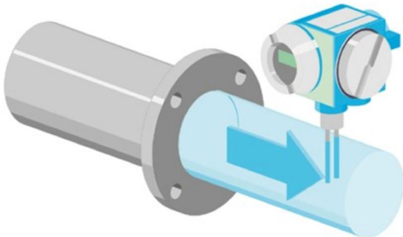
Рисунок 5.28. Технологическая схема термального-массового расходомера.
