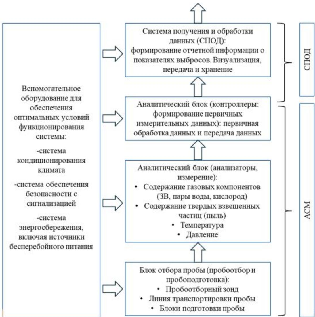
Рисунок 5.3. Функциональная схема автоматической системы контроля выбросов.
