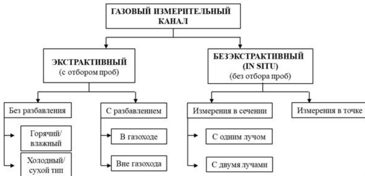
Рисунок 5.5. Классификация газоаналитических измерительных каналов.
