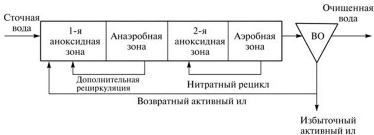
Рисунок 5.9. Модернизированная технологическая схема JHB (Йоханнесбургская технология)
