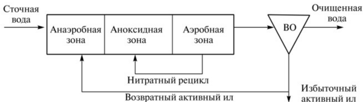
Рисунок 5.2. Технологическая схема АА/О (анаэробно-аноксидная/оксидная зона)
