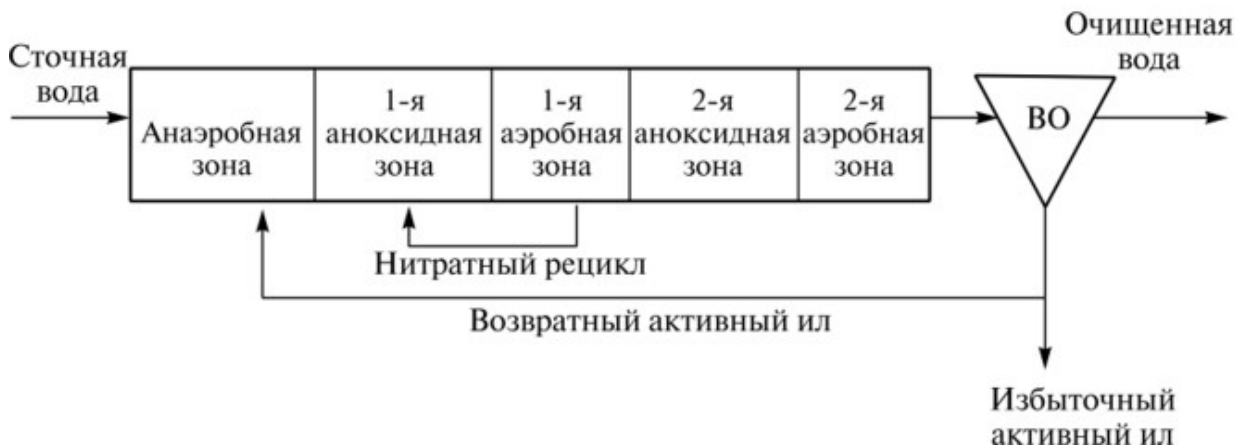
Рисунок 5.7. Модернизированная технологическая схема Барденфо
