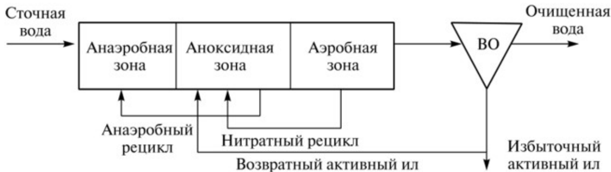
Рисунок 5.4. Технологическая схема UCT (Кэйптаунского университета)
