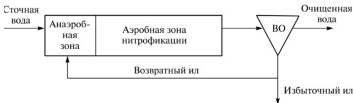
Рисунок 5.1. Технологическая схема А/О (анаэробно-оксидный)
