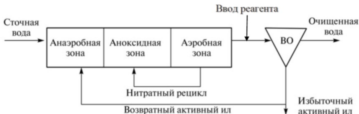
Рисунок 5.3. Модифицированная технологическая схема АА/О (анаэробно-аноксидная/оксидная зона)
