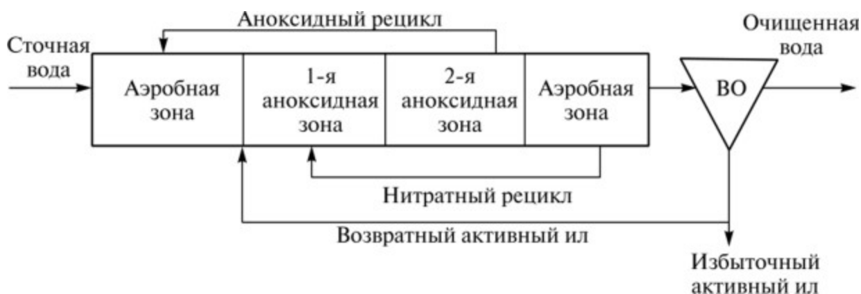
Рисунок 5.10. Технологическая схема VIP (Virginia Initiative Process)
