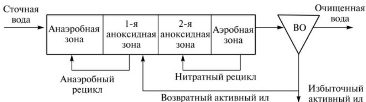
Рисунок 5.5. Модернизированная технологическая схема UCT (Кэйптаунского университета)
