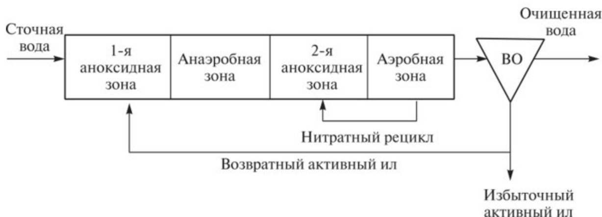
Рисунок 5.8. Технологическая схема JHB (Йоханнесбургская технология)
