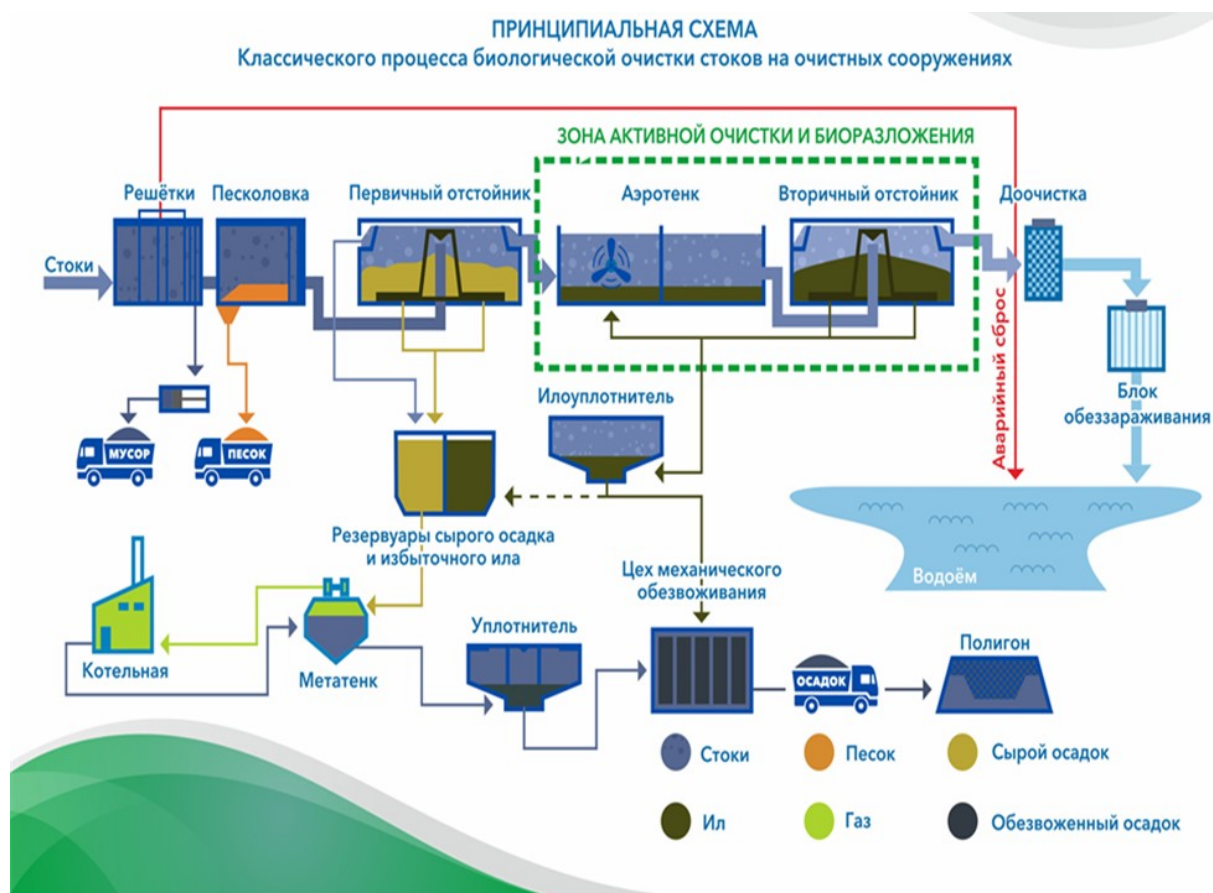
Рисунок 5.21. Классическая схема биологической очистки стоков Биологический и биохимический методы
