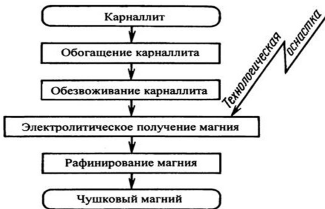
Рисунок 3.2. Технологическая схема получения магния
