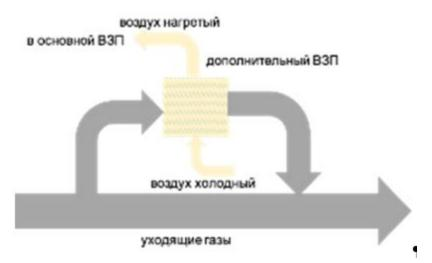
Рисунок 4.46. Схема установки дополнительного воздухоподогревателя на уходящих газов
