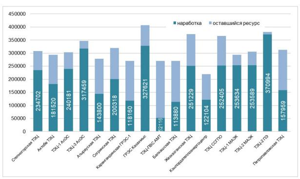
Рисунок 1.7. Средняя наработка турбоагрегатов на давление пара 90 кг/см2
