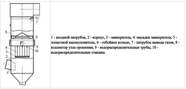
Рисунок 4.7. Схема батарейного эмульгатора второго поколения
