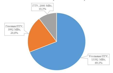
Рисунок 1.10. Структура ТЭС Казахстана по технологии производства энергии
