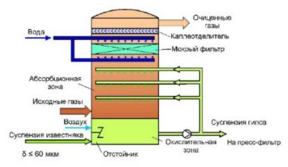
Рисунок 4.12. Конструкция абсорбера мокрой сероочистки [37]
