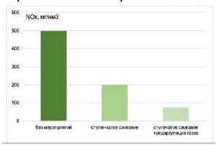
1 - без мероприятий; 5 - ступенчатое сжигание; 6 - ступенчатое сжигание + рециркуляция газов
