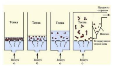
Рисунок 5.1. Основные технологические схемы сжигания угля в топочной технике
