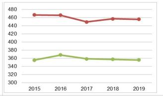
Рисунок 1.16. УРУТ по отпуску электрической энергии КЭС с пылеугольными блоками 500 и 300 МВт, г/кВтч (по данным КТА МЦЗТ и ИП)
