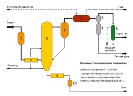
1-Загрузочный бункер; 2-Загрузочный шнек; 3-Газогенератор высокотемпературный по Винклеру; 4-Циклонный сепаратор; 5-Котел-утилизатор; 6-Фильтр; 7-Воронка-затвор; 8-Мокрая очистка от пыли; 9-Охлаждающий шнек; 10-Система воронок-затворов;
