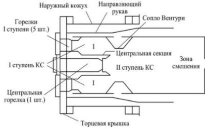
Рисунок 3.8 Принципиальная схема КС типа DLN фирмы GE
