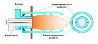
Рисунок 4.19. Низко эмиссионная горелка с затянутым смесеобразованием
