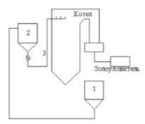
1 - силосная башня для хранения размолотого известняка; 2 - расходный бункер; 3 - система пневмотранспорта известняка в топку котла и его распределения в поперечном сечении топочной камеры
