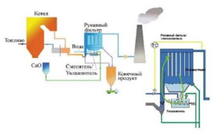
Рисунок 4.16. Схема полусухой сероочистки по NID технологии Alstom
