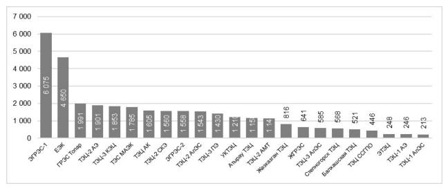
Рисунок 1.15. Расход условного топлива на ТЭС в 2019 году, тыс. тут (по данным КТА МЦЗТ и ИП)
