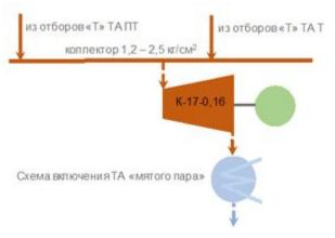
Рисунок 5.59. Схема включения турбины «мятого» пара
