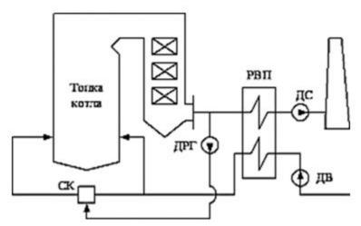
Рисунок 4.26. Типичная схема рециркуляции дымовых газов в топку котла
