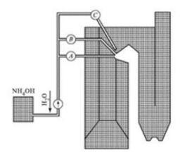
Рисунок 4.29. Различные способы ввода аммиачной воды в поток
