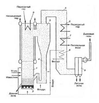
1- экранированная топка, 2-воздухораспределительная колпачковая решетка, 3-циклон, 4-система рециркуляции золы (пневмомеханический затвор), 5-конвективная шахта котла, 6-пароперегреватель, экономайзер, 8-воздухоподогреватель, 9-электрофильтр Рисунок 5.7. Принципиальная схема котла ЦКС системы «Пирофлоу»
