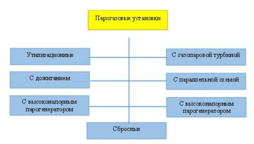
Рисунок 3.11. Классификация парогазовых установок по способам утилизации тепловой энергии выхлопных газов ГТУ
