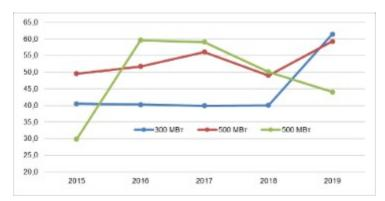
Рисунок 1.29. Энергоемкость КЭС с угольными блоками 300 и 500 МВт, тут/млн тенге, [17]
