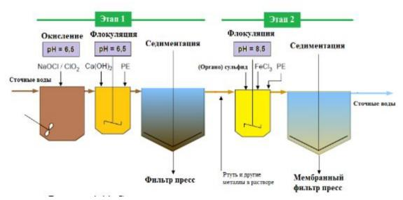
Рисунок 4.44. Станция двухэтапной очистки сточных вод
