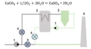
1 – дымосос; 2 – регенеративный подогреватель;3 – абсорбер; 4 – шибер; 5 – дымовая труба
