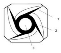
1 - поток первичного воздуха с угольной пылью; 2 - вторичный воздух; 3 - зона, обогащенная топливом
