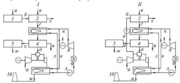
І - кислородное дутье; ІІ - воздушное дутье; основные элементы схемы: 1 - кислородная станция; 2 - газификация; 3 - охлаждение сырого газа; 4 - очистка газа; 5 - выделение серы; 6 - ГТУ; 7 - котел-утилизатор; 8 - парогазовая турбина; 9 - конденсатор; 10 - дымовая труба; 11 - нагнетатель, повышающий давление воздуха; материальные потоки: а - воздух; б - кислород; в - уголь; г - сырой газ; д - очищенный газ; е - сорбент; ж - сорбент; з - зола; и - пыль; к - пар; л - вода; м - уходящие газы
