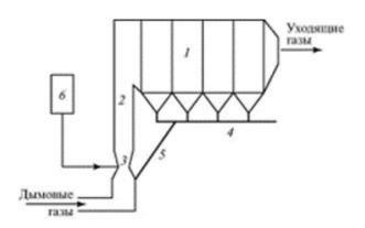
1- электрофильтр (рукавный фильтр), 2 - подводящий газоход, 3 - зона ввода реагента, 4 - система пневмотранспорта уловленной золы, 5 - золопровод возврата части уловленной золы в подводящий газоход, 6 - узел приготовления, хранения и подачи известковой суспензии.
