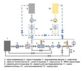
Рисунок 5.39. Комбинированная схема подготовки ВМЭ
