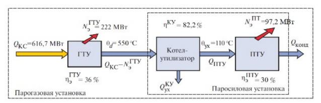
Рисунок 3.13. Диаграмма потоков мощности в утилизационной ПГУ
