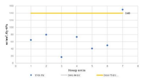
Рисунок 5.27. Удельные выбросы окиси углерода (СО)
