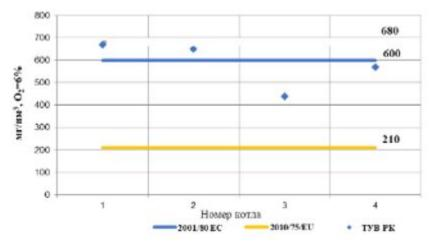
Рисунок 5.14. Удельные выбросы диоксида азота ( $NO_x$ )
