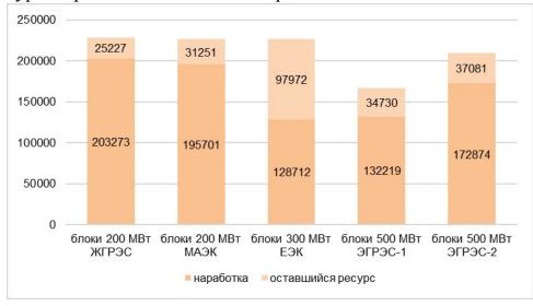
Рисунок 1.5. Средняя наработка генерирующего оборудования блочных ТЭС
