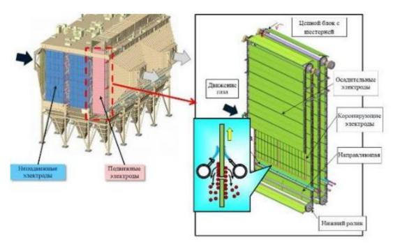
Рисунок 4.5. Электрофильтр с подвижными электродами
