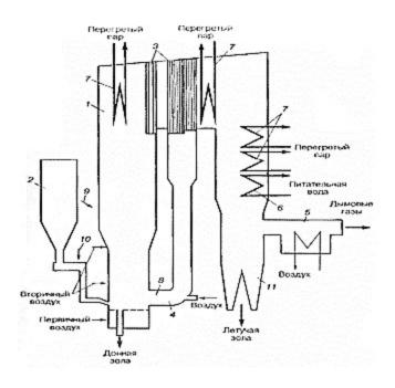
1-топка с испарительными поверхностями, 2-бункер угля, 3-швеллерковые сепараторы, 4- L-клапан, 5-воздухоподогреватель, 6-экономайзер, 7- ступени пароперегревателя, 8-рециркуляция КЗО, 9-рециркуляция летучей золы, 10-сорбент, 11-мультициклон
