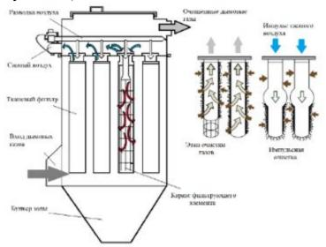
Рисунок 4.6. Схема рукавного фильтра с импульсной очисткой
