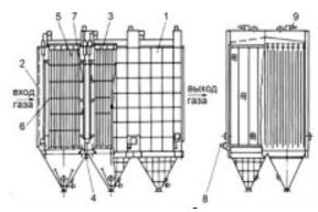
1 - корпус; 2 - газораспределительная решетка; 3 - осадительный электрод; 4 - механизм встряхивания осадительных электродов; 5 - коронирующий электрод; 6 - рама подвеса коронирующих электродов; 7 - механизм встряхивания коронирующих электродов; 8,9 - привод встряхивания осадительных и коронирующих электродов
