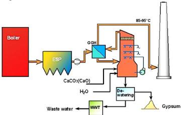
Boiler - котел; ESP - электрофильтр; GGH - теплообменник; Dewatering - удаление влаги; WWT - очистка воды; Gypsum - гипс.
