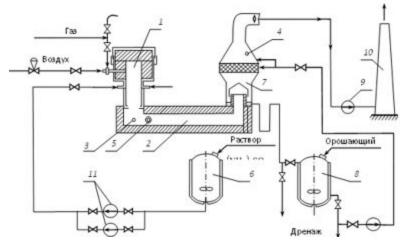
1 - циклонный реактор; 2 - газоход; 3, 4 - пробоотборные точки; 5 - форсунка; 6 - емкость с раствором сульфата аммония; 7 - насадочный скруббер; 8 - емкость с орошающим раствором; 9 - дымосос; 10 - дымовая труба; 11 - насосы
