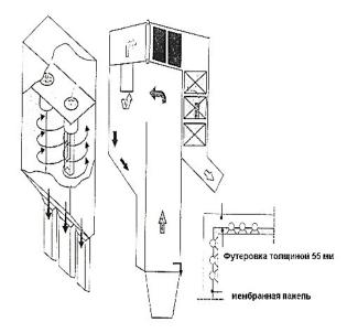
Рисунок 5.8. Схема компактных сепараторов золы
