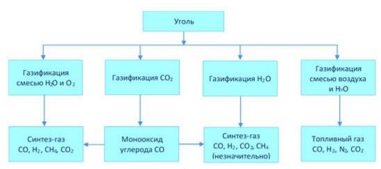
Рисунок 3.14. Способы газификации угля
