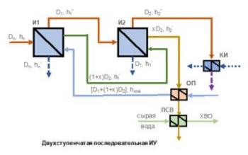
Рисунок 5.56. Схема двухступенчатой последовательной испарительной установки
