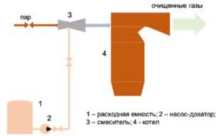
Рисунок 5.41. Схема СНКВ
