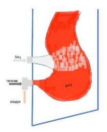
Рисунок 5.36. Схема двухступенчатого сжигания
