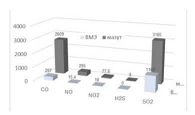
Рисунок 5.35. Концентрации ЗВ при сжигании мазута и ВМЭ на котлах ТГМ-84
