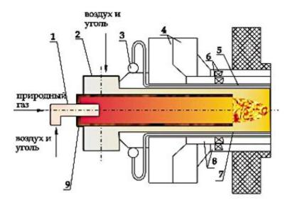
а - схема процесса термохимической подготовки: 1 - канал подачи на ТХП; 2 - улитка первичной аэросмеси; 3 - коллектор подсветочного газа; 4 - улитка вторичного воздуха; 5 - трубки подачи газа; 6 - аксиальные регистры; 7 - канал первичной аэросмеси; 8 - канал вторичного воздуха; 9 - муфель
