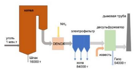
Рисунок 1.50. Ежегодное образование ЗШО на электростанции мощностью 450 МВт при 6 000 часов полной нагрузки (общее образование ЗШО 187000 тонн)
