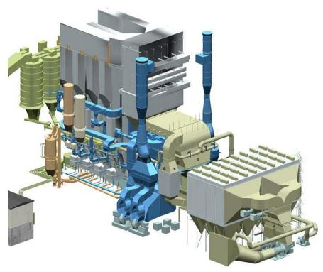
Рисунок 5.9. Энергоблок с ЦКС мощностью 460 МВ
