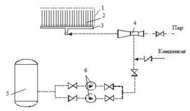
1- устройство для впрыска аммиака в газоход, 2-раздающие трубы,3-коллектор, 4-смеситель, 5-емкость, 6-насос-дозатор
