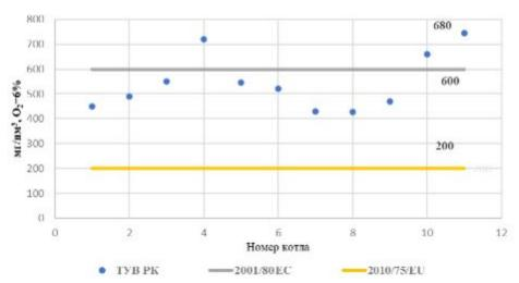
Рисунок 5.25. Удельные выбросы диоксида азота ( $NO_x$ )
