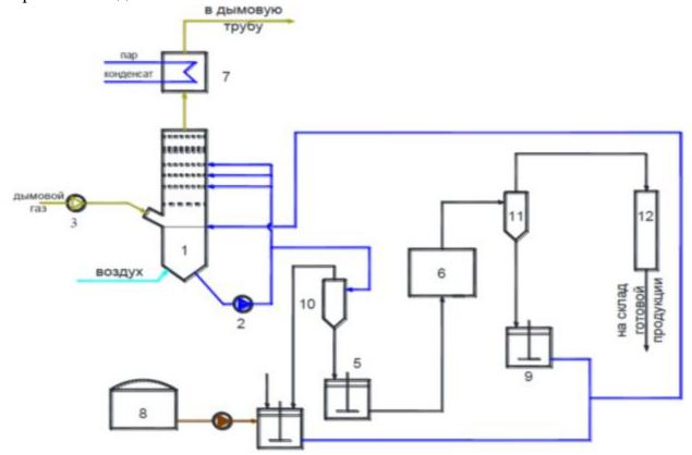
1 - абсорбер; 2 - циркуляционный насос; 3 - нагнетатель; 4 - емкость нейтрализатор; 5 - напорная емкость; 6 - выпарной аппарат; 7 - подогреватель дымового газа; 8 - склад аммиака; 9 - емкость для маточного раствора; 10 - гидроциклон; 11 - центрифуга; 12 - сушильный барабан
