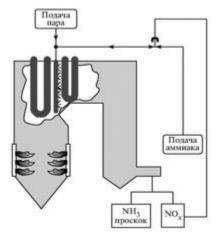
Рисунок 4.28. Схема организации процессов СНКВ
