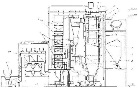
1 - бункер топлива; 2 - экраны топки; 5 - питатель топлива; 4 - циклон; 5 - барабан; 6 - пароперегреватели; 7 - подвесные трубы; 8 - экономайзер; 9 - воздухоподогреватель; 10 - золоуловитель; II - дымосос; 12 - дутьевой вентилятор
