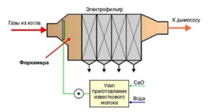
Рисунок 4.13. Принципиальная схема упрощенной мокросухой известковой сероочистки [37]
