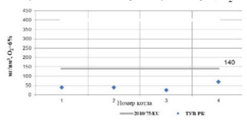
Рисунок 5.16. Удельные выбросы окиси углерода (СО)
