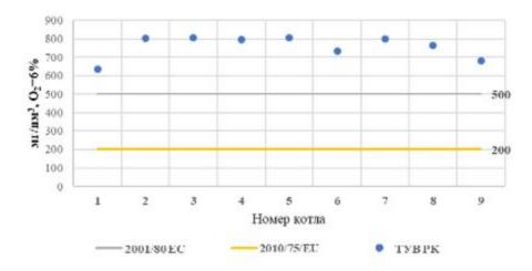
Рисунок 5.29. Удельные выбросы диоксида азота ( $NO_x$ )
