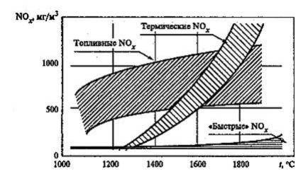
Рисунок 4.18. Зависимость образования оксидов азота от температуры при сжигании органического топлива
