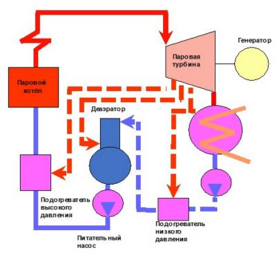
Рисунок 3.1. Принципиальная схема КЭС
