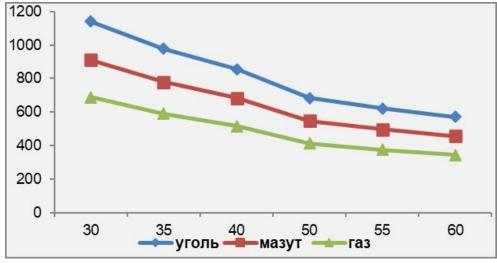
Рисунок 1.35. Выбросы  $CO_2$ , г/к $B_{T_*}$ ч в зависимости от КПД (нетто), %
