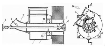
Рисунок 5.2. Вихревая пылеугольная горелка ОРГРЭС
