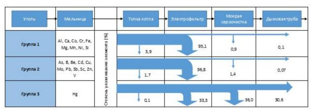
Рисунок 4.38. Массовый баланс тяжелых металлов на электростанциях, работающих на угле
