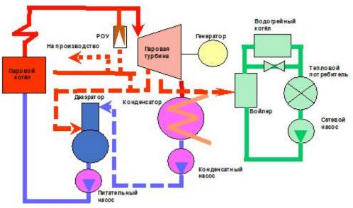
Рисунок 3.3. Принципиальная тепловая схема ТЭЦ
