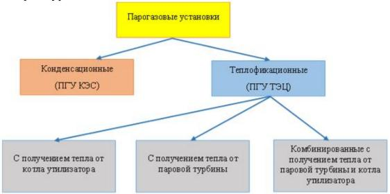
Рисунок 3.10. Классификация парогазовых установок по назначению
