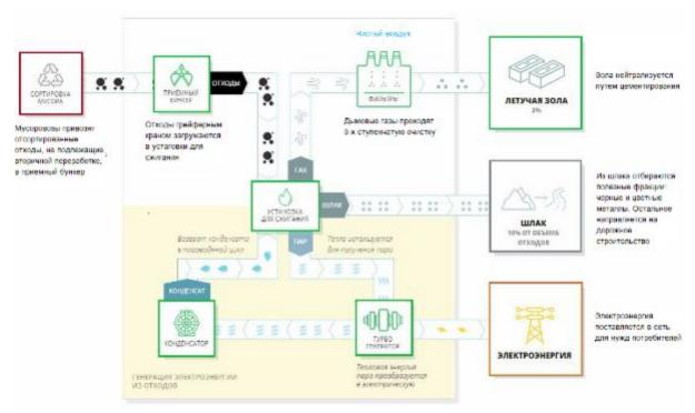
Рисунок 5.47. Структура предприятия по термической переработке ТКО
