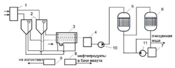
1 - распределительная камера; 2 - приемные резервуары; 3 - нефтеловушка; 4 - промежуточный резервуар; 5 - механический фильтр; 6 - сорбционный (угольный) фильтр; 7 - резервуар очищенной воды; 8 - резервуар уловленных нефтепродуктов; 9 - резервуар осадка; 10 - насос подачи очищаемой воды на фильтры; 11 - насос взрыхляющей промывки фильтров
