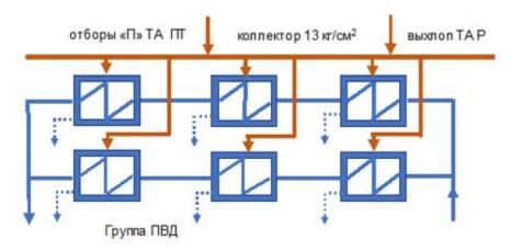
Рисунок 5.55. Групповая схема включения ПВД
