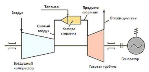
Рисунок 3.5. Принципиальная схема простейшей ГТУ
