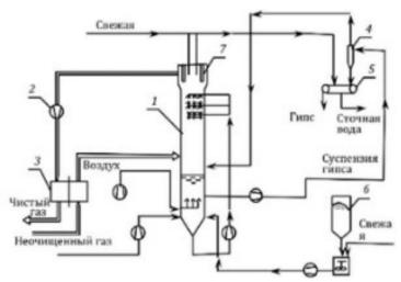
1 - скруббер (абсорбер); 2 - дымосос; 3 - теплообменник; 4 - гидроциклон; 5 - вакуум-фильтр; 6 - расходный бункер известняка; 7 - каплеуловитель
