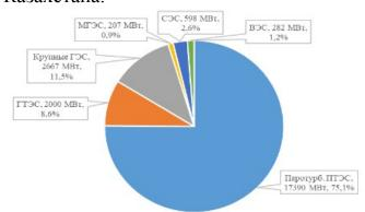
Рисунок 1.1. Структура генерирующих мощностей
