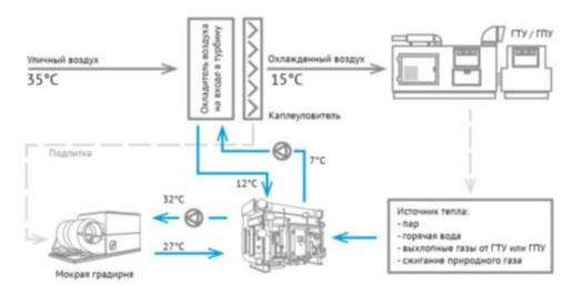
Рисунок 7.5. Структурная схема АБХМ
