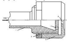
1 - форсунка; 2 - контргайка; 3 - головка форсунки;
