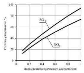
Рисунок 4.34. Зависимость степени улавливания  ${\rm SO}_2$  и  ${\rm NO}_{\rm x}$  от доли стехиометрического соотношения соответственно  ${\rm NH}_3$  и  ${\rm O}_3$
