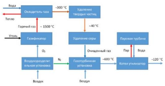
Рисунок 3.17. Блок-схема процессов в цикле ПГУ с ВЦГ
