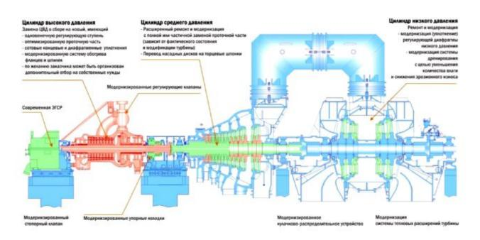
Рисунок 5.57. Схема реконструкции Т-100-130
