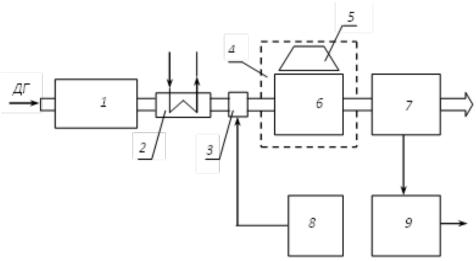
ДГ - дымовые газы; 1 - электрофильтр; 2 - теплообменник; 3 - смеситель; 4 - радиационная защита; 5 - ускоритель электронов; 6 - реактор; 7 - фильтр; 8 - узел хранения, подготовки и подачи аммиака; 9 - гранулятор смеси сульфата и нитрата аммония
