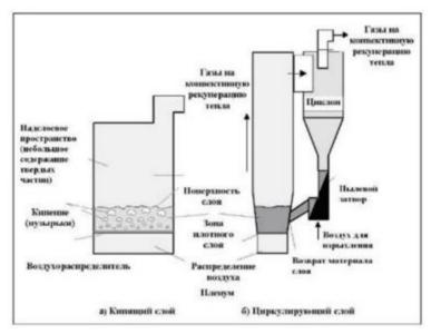
Рисунок 5.4. Схемы сжигания угля в кипящем слое (ПКС и ЦКС)
