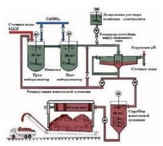
Рисунок 4.43. Установка очистки сточных вод мокрой системы десульфуризации
