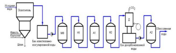
Рисунок 4.39. Схема химического обессоливания воды
