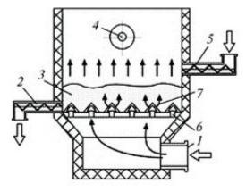
1 - подвод дутьевого воздуха; 2 - выгрузка из топки золы и отработанного песка; 3 - кипящий (псевдоожиженный) слой; 4 - растопочная горелка; 5 - загрузка топлива и свежего песка; 6 - каналы в воздухораспределительной решетке; 7 - подвод воздуха через колокольчики на воздухораспределительной решетке
