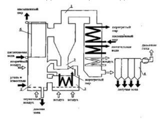
1 - циклон, 2 - топка, 3 - теплообменник кипящего слоя, 4 - рукавный фильтр, 5 - пневмомеханический затвор U-образного типа, 6 - испарительные поверхности нагрева. Рисунок 5.6. Принципиальная схема ЦКС-котлоагрегата системы «Лурги»
