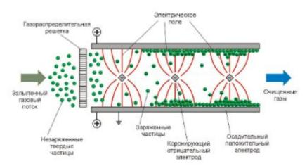
Рисунок 4.2. Принцип работы электрофильтра
