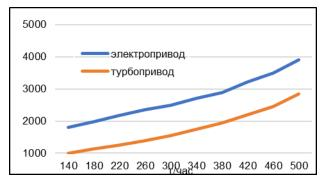
Рисунок 5.55. Изменение мощности привода(кВт) от расхода питательной воды
