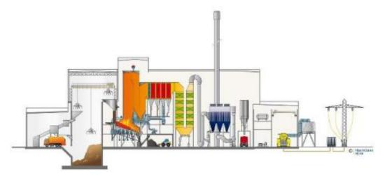
Рисунок 5.48. Схематическое представление предприятия термической переработки ТКО посредством прямого сжигания на движущейся решетке Edinburgh, UK Hitachi Zosen Inova
