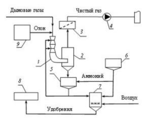
1 - скруббер; 2 - каплеуловитель; 3 - подогреватель; 4 - дымосос; 5 - циркуляционная емкость; 6 - емкость аммонийного раствора; 7 - реактор; 8 - узел подготовки удобрений; 9 - озонатор
