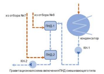
Рисунок 5.54. Гравитационная схема Парсонс включения ПНД смешивающего типа
