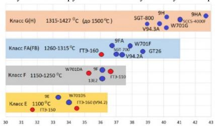
Рисунок 3.6. Показатели эффективности ГТУ в зависимости от температуры газов на входе в газовую турбину
