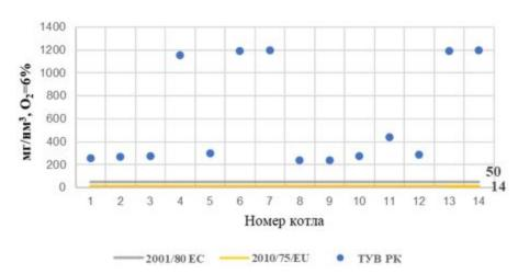
Рисунок 5.22. Удельные выбросы пыли за электрофильтрами при  $A_{\rm np} > 2,5~\%$  кг/ МДж
