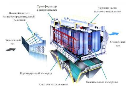
Рисунок 4.3. Общий вид стандартного сухого электрофильтра
