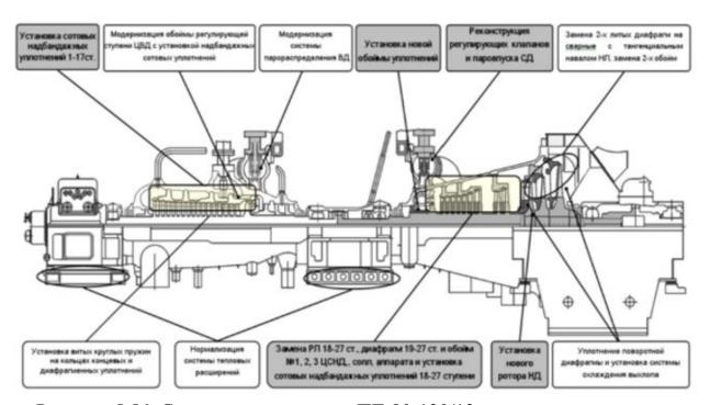
Рисунок 5.56. Схема реконструкции ПТ-80-130/13
