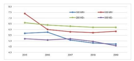
Рисунок 1.31. Расход электроэнергии на СН по отпуску электроэнергии угольных КЭС СКД, блок 200 МВт на давление 140 кг/см $^2$  на газе, % (по данным КТА МЦЗТиИП )
