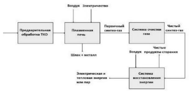
Рисунок 5.52. Блок-схема газификации ТКО с использованием плазменных источников энергии
