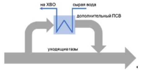
Рисунок 4.47. Схема включения дополнительного ПСВ от уходящих газов
