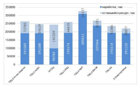
Рисунок 1.6. Средняя наработка турбоагрегатов давлением пара 130 кг/см<sup>2</sup>
