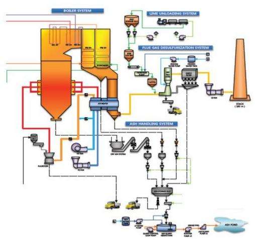
Рисунок 5.31. Блок-схема комбинированной системы ЗШУ с отгрузкой потребителям сухой золы из УОСЗ и шлака из-под котлов
