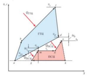
Рисунок 3.9. Простейший утилизационный парогазовый цикл
