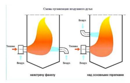
Рисунок 4.22. Схема технологии двухступенчатого сжигания
