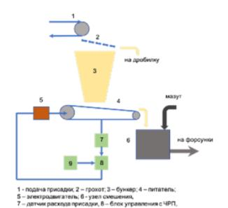
Рисунок 5.40. Схема подачи смеси
