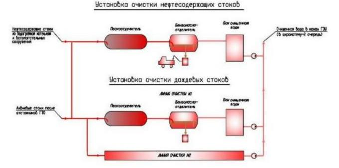
Рисунок 4.42. Схема установки очистки нефтесодержащих стоков совместно с очисткой поверхностного стока с территории
