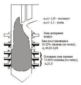
Рисунок 4.23. Схема организации трехступенчатого сжигания
