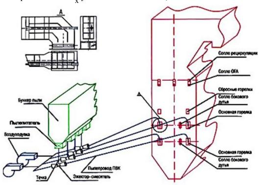
Рисунок 4.27. Схема подачи пыли высокой концентрации
