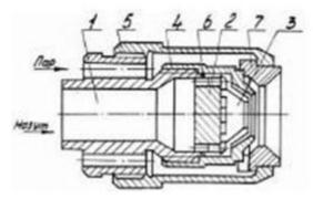
1 - ствол форсунки; 2 - рассекатель; 3 -мазутное сопло; 4 - регулировочное кольцо; 5 - головка форсунки; 6 - паровое сопло; 7 - выходное сопло
