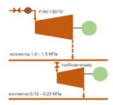
Рисунок 5.58. Схема включения турбодетандера
