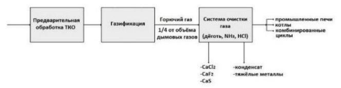
Рисунок 5.51. Блок-схема обычного процесса газификации ТКО
