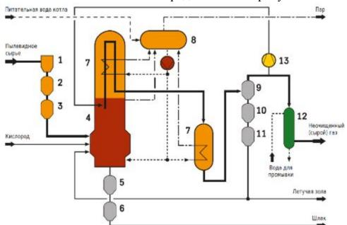
1.-Циклонный фильтр; 2.-Воронка-затвор; 3.-Загрузочный бункер 4.-Газогенератор; 5.-Дробилка/коллектор шлака; 6.-Воронка-затвор для шлака; 7.-Котел-утилизатор; 8.- Паросборник; 9.- Фильтр; 10.- Воронка-затвор летучей золы; 11.- Загрузочный бункер для летучей золы; 12.- Скруббер; 13.- Компрессор закалочного газа.
