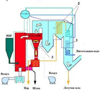
1 - экономайзер; 2 - конвективный пароперегреватель; 3 - циклоны Рисунок 5.50. Котел с ЦКС для сжигания бытовых отходов, установленный на предприятии Lomellina (Италия) [24]
