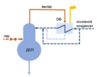
Рисунок 5.64. Схема включения охладителя выпара
