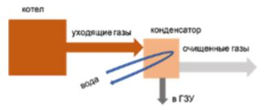
Рисунок 5.44. Схема включение конденсатора дымовых газов
