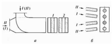
Рисунок 5.3. Принципиальная схема прямоточных горелок
