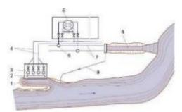
1 - водозаборный ковш; 2 - водоприемник; 3 - централизованная береговая насосная станция; 4 - магистральные подземные напорные трубопроводы; 5 - конденсатор турбины; 6 - сливной сифонный колодец (гидрозатвор); 7 - отводящие самотечные подземные каналы; 8 - открытый отводящий канал; 9 - трубопровод обогрева водозабора в зимнее время.
