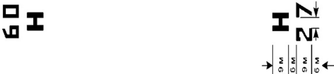
**Рис. Маркировка обозначения зоны FATO**
