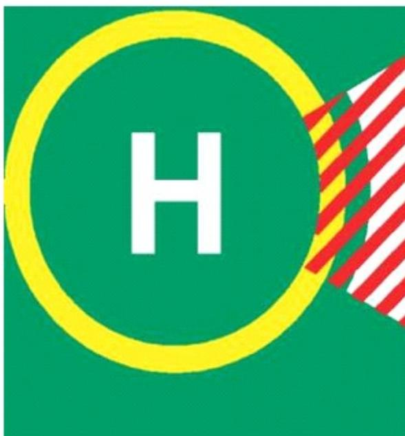
**Рис. Маркировка запрещенного для посадки сектора вертопалубы**
