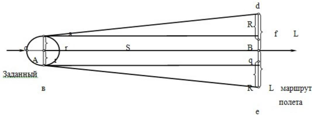
1) на рабочей карте наносится участок (AB) заданного маршрута полета BC, потерпевшего бедствие, от последней контрольной точки, при пролете которой с ним имелась связь (точка A), до точки, в которую он не прибыл или в которой с ним не была установлена связь (точка B);
