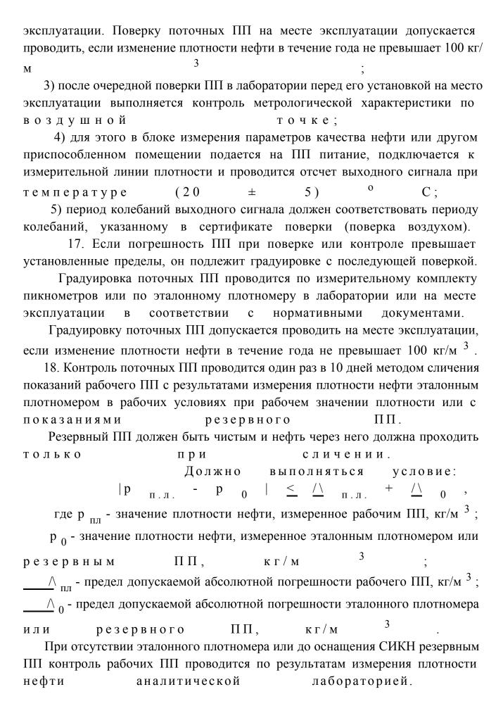
Не реже одного раза в 10 дней показания ПП р  $_{\rm пл}$  сравниваются с результатами измерения плотности нефти ареометром или лабораторным плотномером и вычисляют разность плотностей  $\bigwedge_{\rm pk}$ , кг/м  $^3$ , по формуле:
