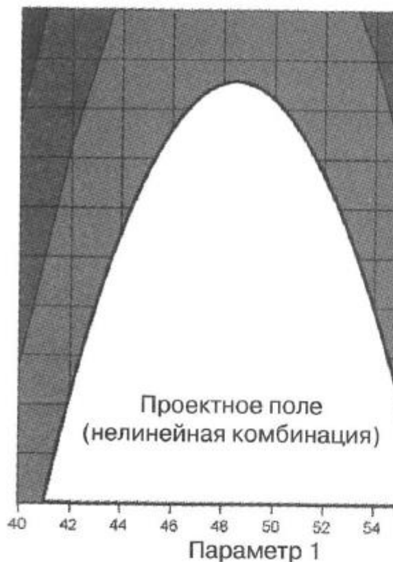
Рисунок 5. Проектное поле для определения параметров гранулирования, заданное нелинейной комбинацией их диапазонов, обеспечивающей приемлемую степень высвобождения (более 80 %)
