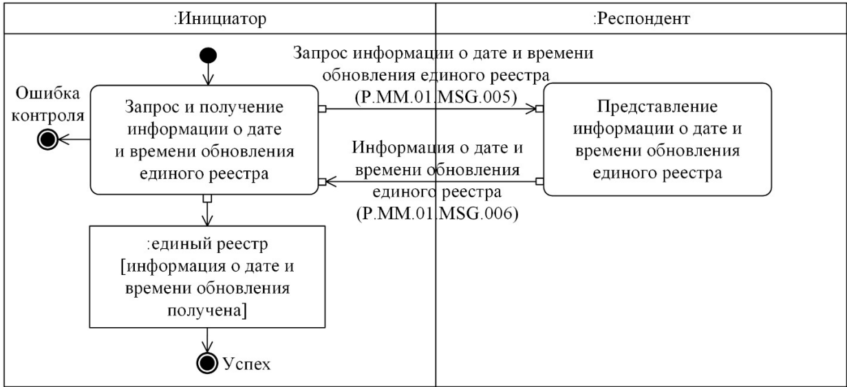
Рис. 7. Схема выполнения транзакции общего процесса "Получение информации о дате и времени обновления единого реестра" (P.MM.01.TRN.004)
