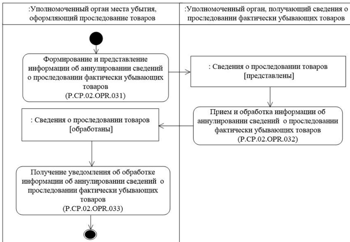
Рис. 15. Схема выполнения процедуры "Аннулирование сведений о проследовании фактически убывающих товаров" (P.SP.02.PRC.011)
