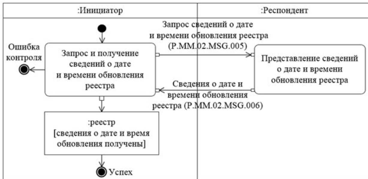
Рис. 7. Схема выполнения транзакции общего процесса «Получение сведений о дате и времени обновления реестра» (P.MM.02.TRN.004)
