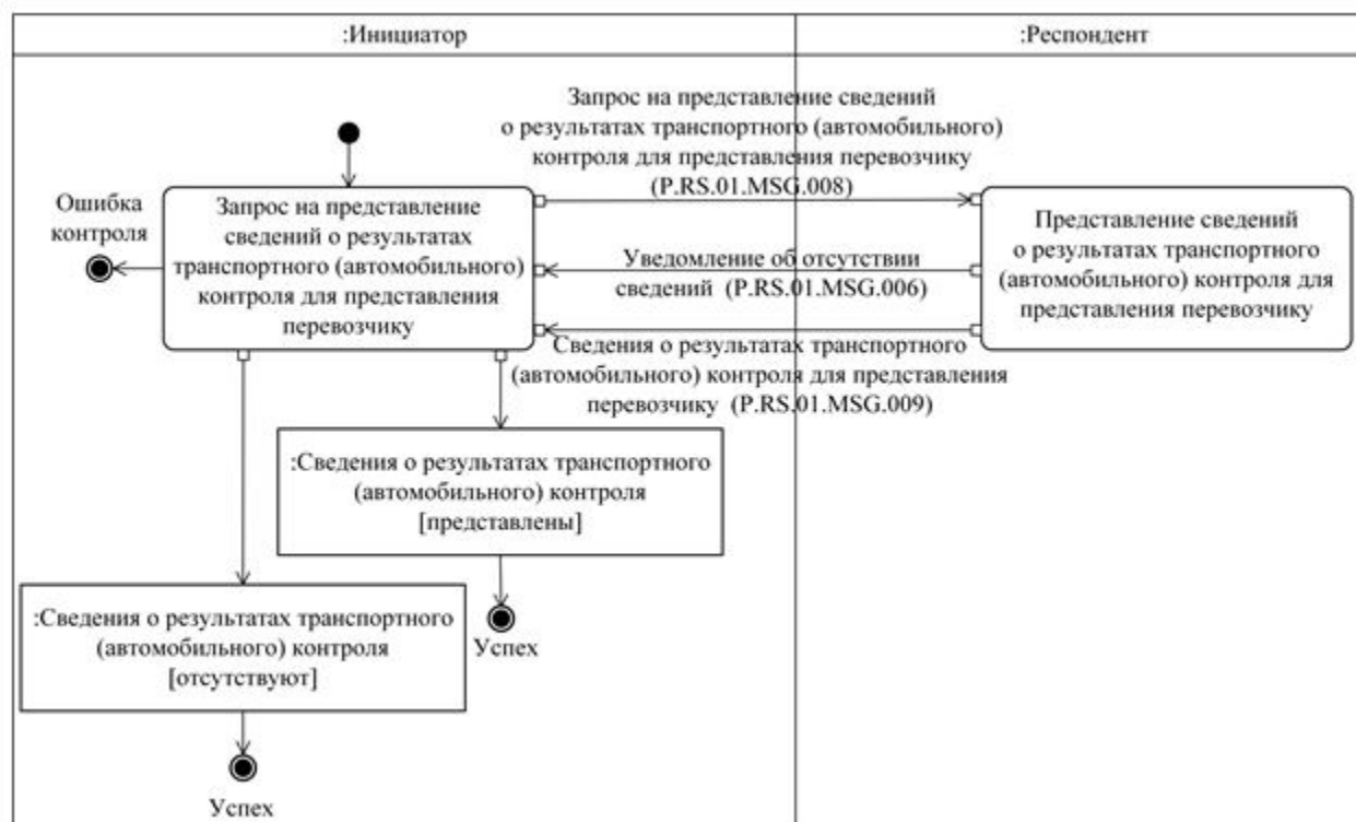
Рис. 8. Схема выполнения транзакции общего процесса «Получение сведений о результатах транспортного (автомобильного) контроля для представления перевозчику» (P.RS.01.TRN.004)
