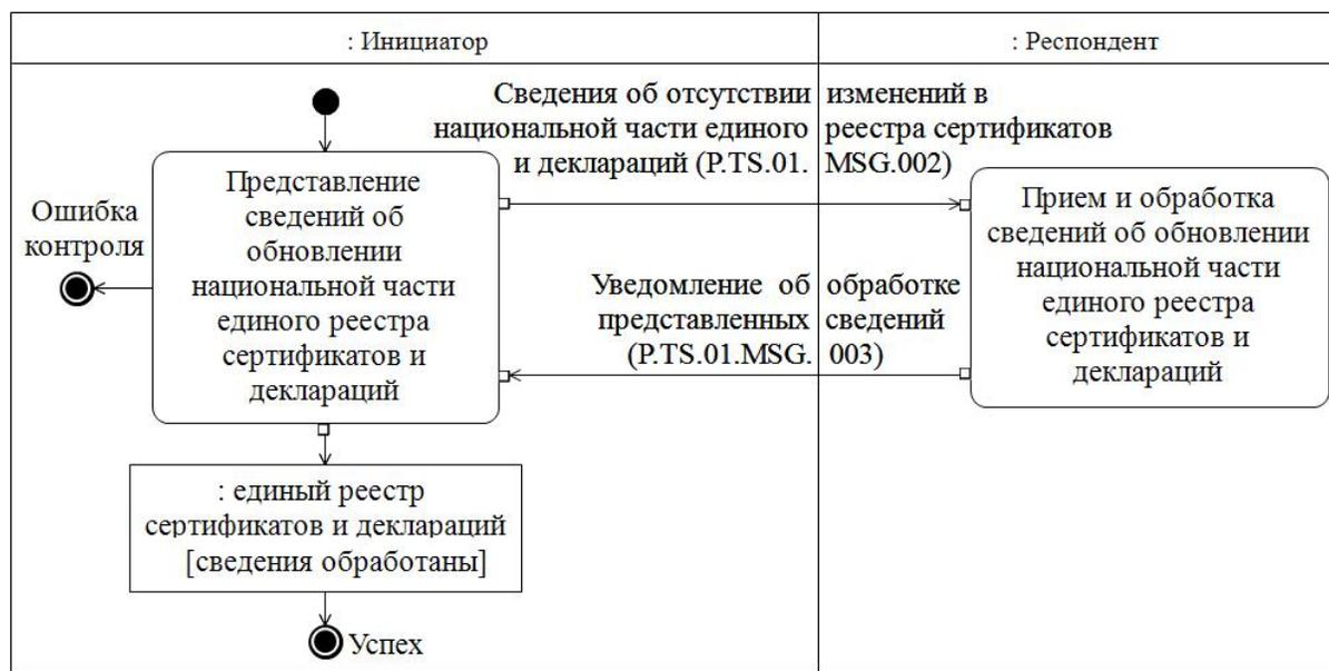
**Рис. 5. Схема выполнения транзакции общего процесса "Передача уведомления об отсутствии изменений в национальной части единого реестра сертификатов и деклараций" (P.TS.01.TRN.002)**
