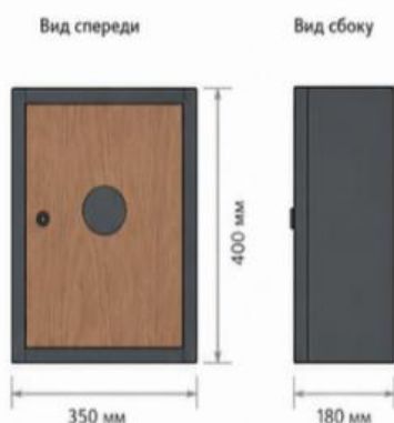
3. Шкаф видеонаблюдения (детали)
