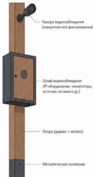
2. Установка камер и шкафа
