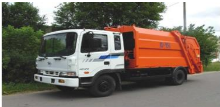
Рисунок 20 - Мусоровоз КО-456-10 с задней загрузкой
