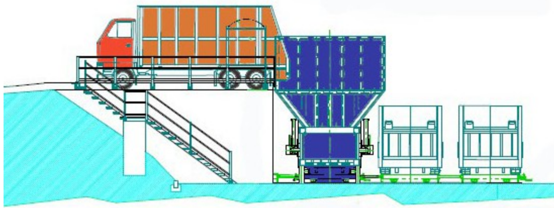
Рисунок 17 - Схема перегрузки отходов на мусороперегрузочной станции
