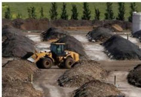
Рис. 16. Площадка для компостирования отсортированной «Мокрой» фракции коммунальных отходов
