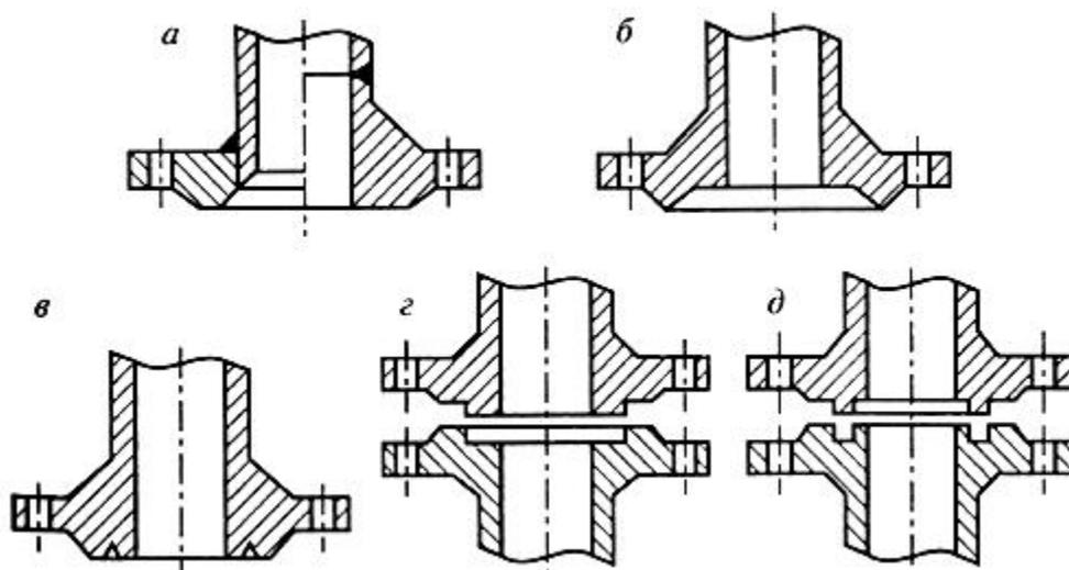
1-сурет. Арматура ернемектері мен құбыр жолдың жалғастыратын бөліктерінің тығыздау бетінің түрін таңдау:
