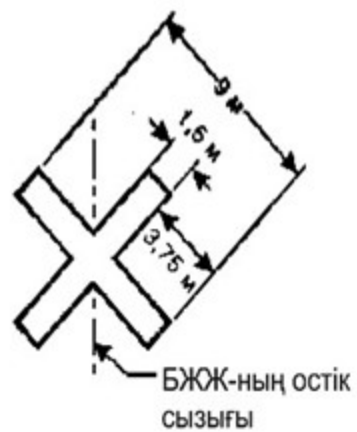
Сурет. Қозғалыс үшін жабық ТҰҚЖ және БРЖ-ны таңбалау
