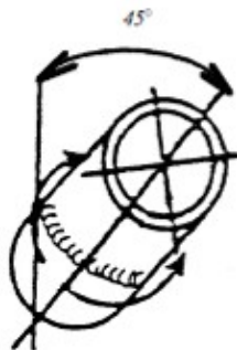
H-L045: көлбеу қалып (төменнен жоғары қарай) Құбыр: қозғалмайды ось: көлбеу
