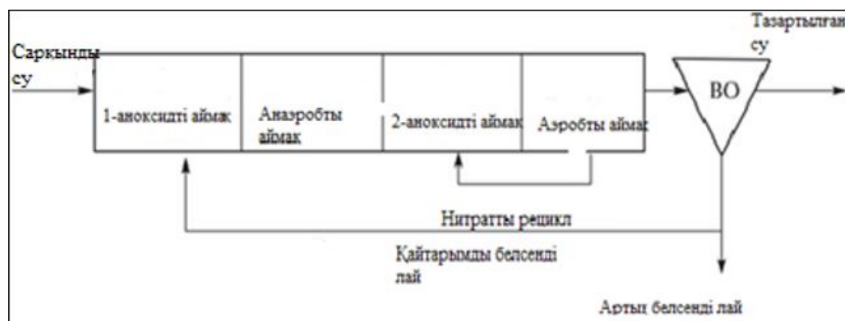
5.-сурет. ЛНВ технологиялық схемасы (Йоханнесбург технологиясы)
