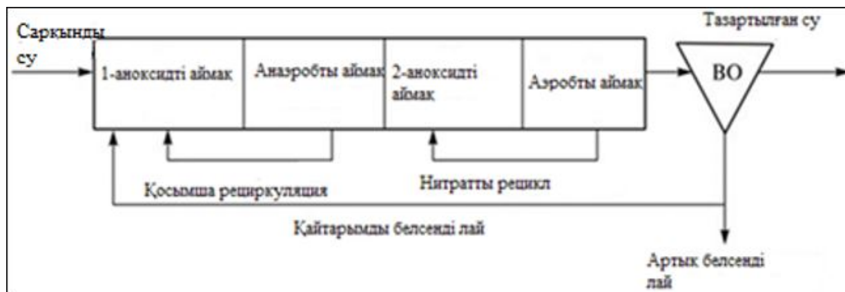
5.9-сурет Түрлендірілген JNB технологиялық схемасы (Йоханнесбург технологиясы )
