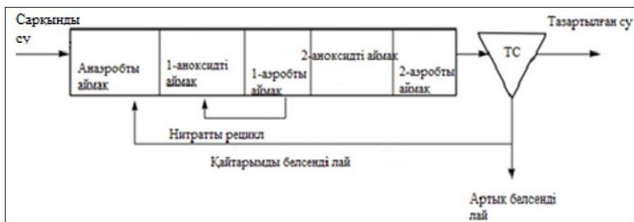
5.7-сурет. Барденфо жаңғыртылған технологиялық схемасы
