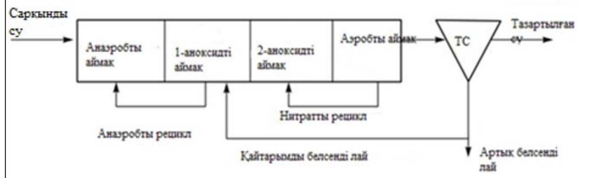
5.4-сурет. UST технологиялық схемасы (Кейптаун университеті)
