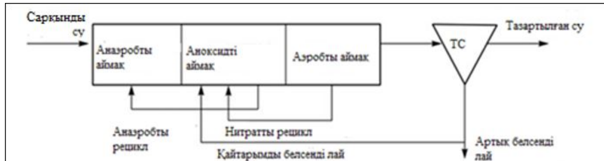
5.4-сурет. UST технологиялық схемасы (Кейптаун университеті)
