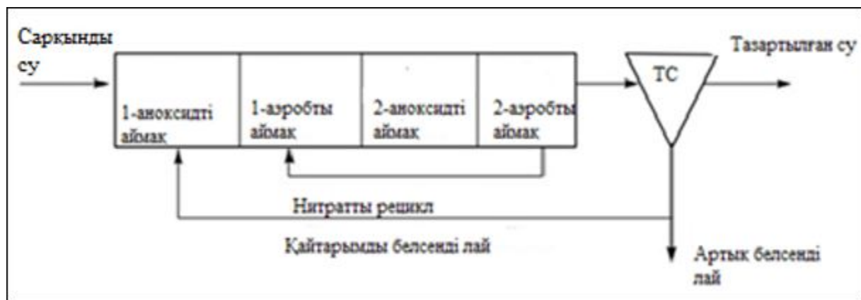
5.6-сурет. Барденфо технологиялық схемасы
