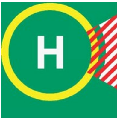
Сурет.Вертопалубаның қонуға тыйым салынған секторының таңбалануы
