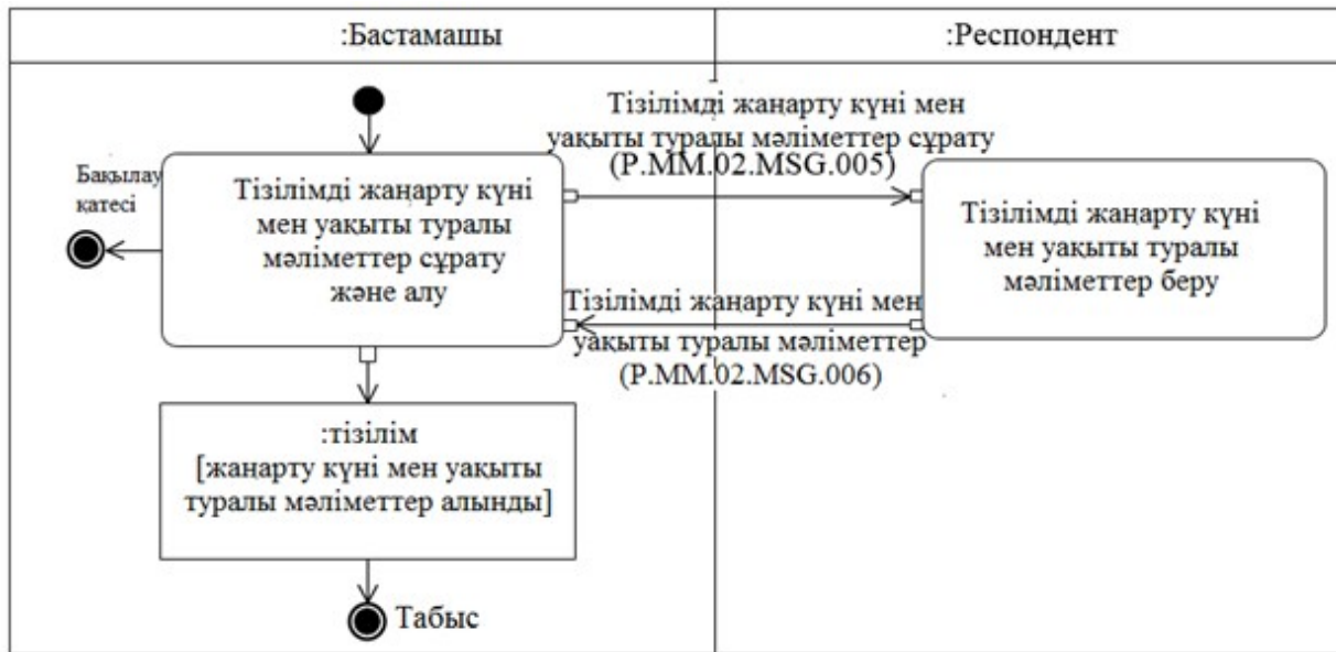
7-сурет. "Тізілімді жаңарту күні және уақыты туралы мәліметтер алу" (P.MM.02.TRN.004) жалпы процесінің транзакциясын орындау схемасы 8-кесте
