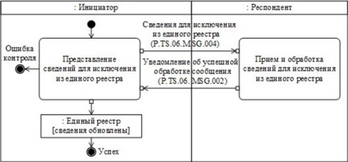
6-сурет. Жалпы процестің "Бірыңғай тізілімнен мәліметтерді алып тастау" (P.TS.06.TRN.003) транзакциясын орындау схемасы 7-кесте
