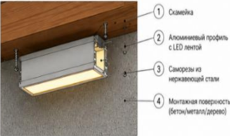
3. УЗЕЛ УСТАНОВКИ (КРЕПЛЕНИЕ ПРОФИЛЯ)
