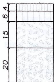
ЖМБ 60/90 битумды Б типті I таңбалы ұсақ түйіршікті ыстық тығыз асфальт-бетон
